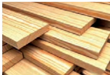
تخته‌های مورد استفاده در قالب‌بندی چوبی:
