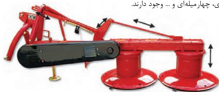
شکل ۴- مکانیزم میله‌ای در دروگر
