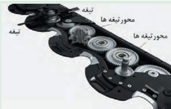
شکل ۵۱ - چرخ دنده‌های محرک تیغه‌ها در دروگر بشقابی
