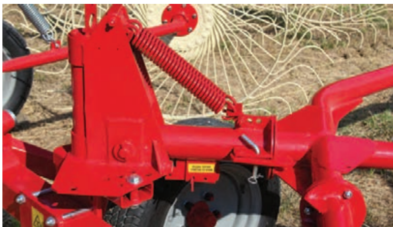
شکل ۱۵- مکانیزم شناوری شانه خورشیدی
