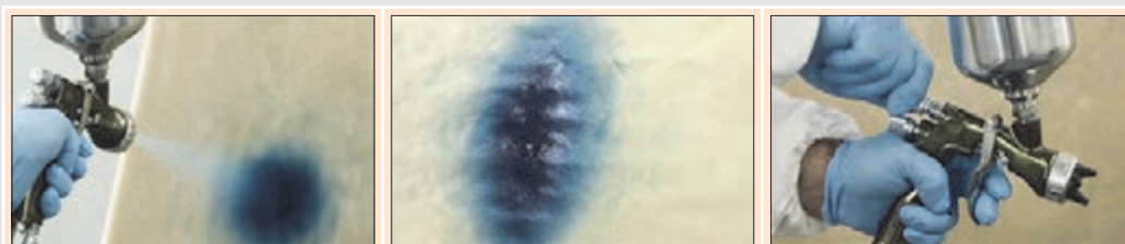
شکل ۶۵- پیچ تنظیم الگوی پاشش و تفاوت‌های ایجاد شده
