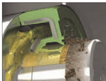
شکل ۶۸- کاسه نمد و نحوه عمل آن
