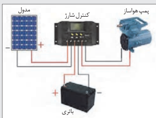
شکل ۴۱- مدار الکتریکی هواساز
