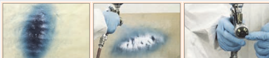
شکل ۶۶- تنظیم جهت پاشش
