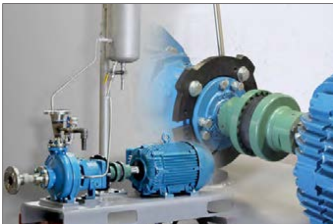
شکل ۸- انتقال قدرت مستقیم از موتور به دستگاه
