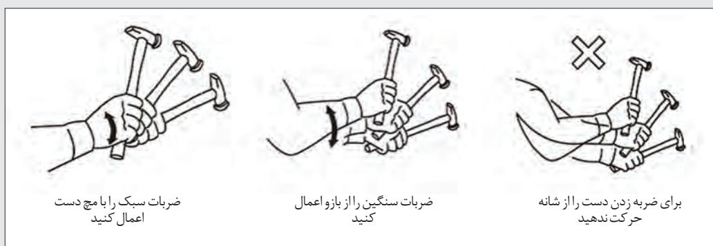
شکل ۵۰- روش ضربه زدن با چکش
