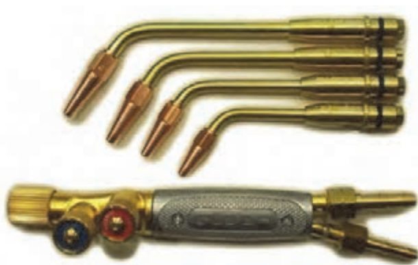
شکل ۶- مشعل جوشکاری و سرمشعل‌های آن
