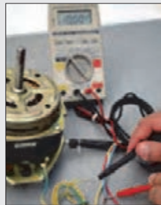
شکل ۷- آزمایش اتصال بدنه
