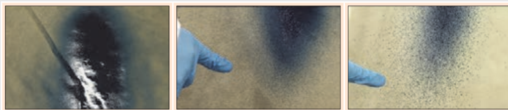
شکل ۶۴- با افزودن فشار، خروجی پیستوله یکنواخت شده است.
