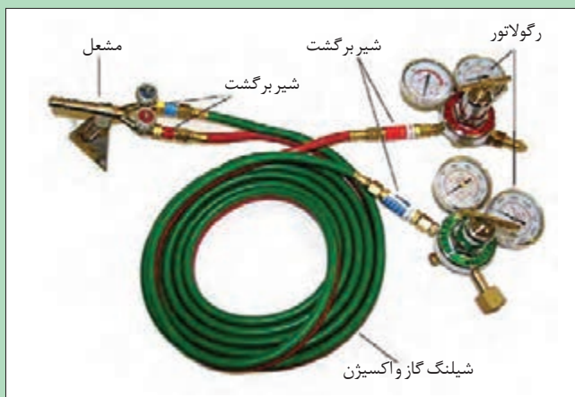
شکل ۱۸- محل نصب سوپاپ های یک طرفه (شیر برگشت)
