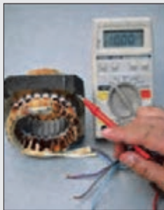
شکل ۷- آزمایش اتصال بدنه
