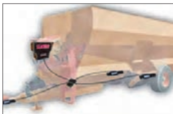
سیستم توزین و کنترل فیدر میکسر
