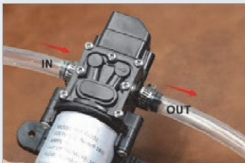
شکل ۳۲- اتصال پمپ و رعایت جهت حرکت سیال
