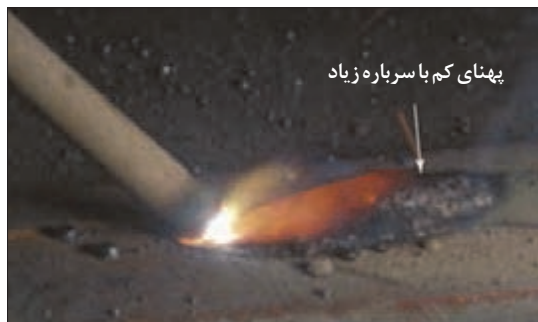
شکل ۳۰- جوشکاری با طول قوس بسیار کم
