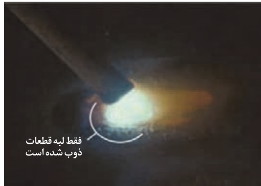
شکل ۴۳- در حرکت مستقیم الکترود نمی‌تواند به خوبی فلز پایه را ذوب کند و در جوش رسوب نماید
