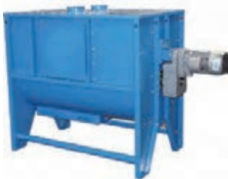
شکل ۸- مخلوط‌کن افقی و مارپیچ‌های آن
