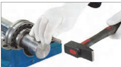
شکل ۶۲- جدا کردن بیرینگ از بوش مخروطی
