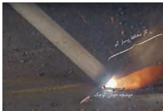
شکل ۲۶- جوشکاری با آمپر بسیار پایین
