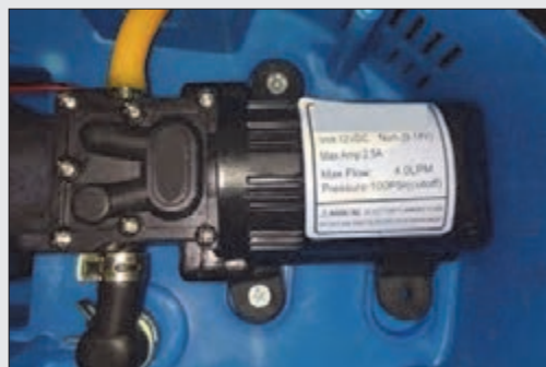
شکل ۳۲- اتصال پمپ و رعایت جهت حرکت سیال
