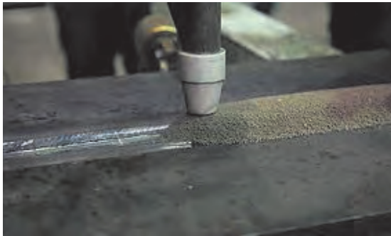
شکل ۷۳ ▲ جوشکاری قوس الکتریکی زیر پودری
