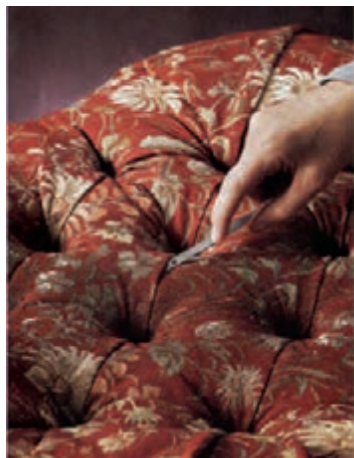
شکل ۴-۶۳- تنظیم لمسه با انتهای سوزن
