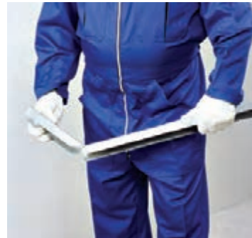
شکل ۱۲۸- خم کردن انتهای رانر نعل درگاه
