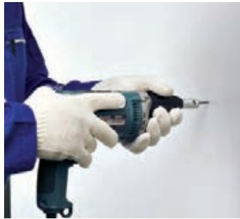
شکل ۱-۶۱- نحوه صحیح در دست گرفتن پیچ گوشتی برقی
