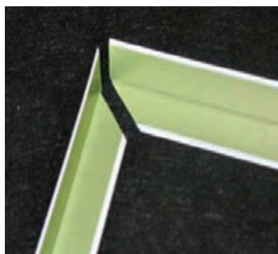
شکل ۱۰۹-۳ فارسی بر شدن نبشی تراز
