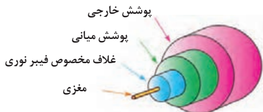
شکل ۴-۸- فیبر نوری و اجزای آن
