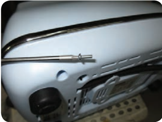
شکل ۶-۴۳ استفاده از ابزار خاص برای پیچ‌های ویژه
