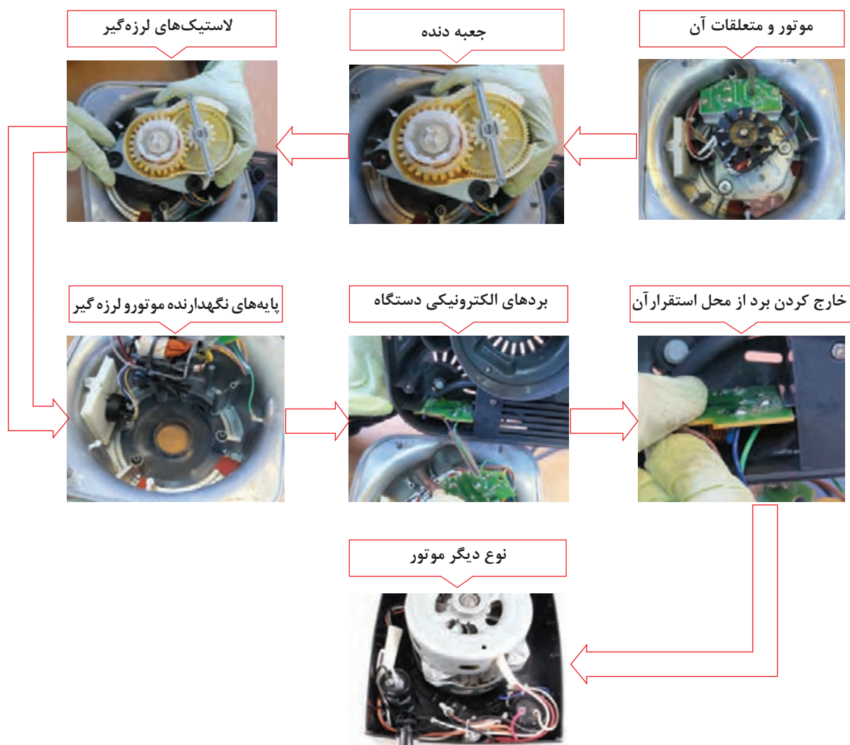
شکل ۱-۲۷- اینفوگرافی جدا کردن برد الکترونیکی دستگاه غذاساز
