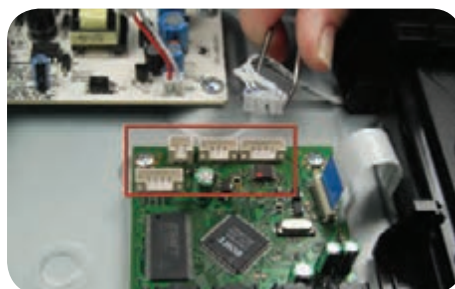
شکل ۶-۱۹ جدا کردن سوکت‌ها از برد پردازشگر
