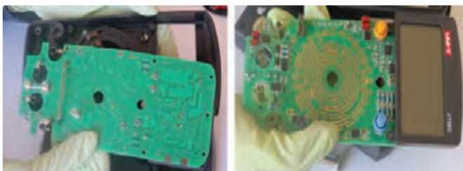
شکل ۱۷-۱ مولتی متر باز شده
