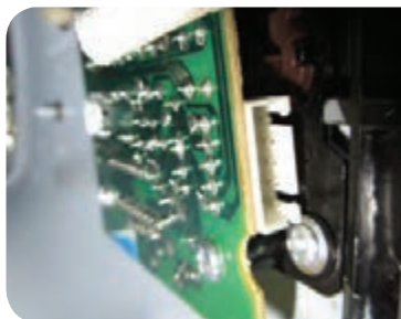
شکل ۶-۵۰ بُرد الکترونیکی شکل ۶-۵۱ محل اتصال سوکت به بُرد الکترونیکی شکل ۶-۵۲ سوکت از بُرد جدا شده است
