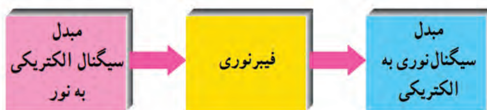
شکل ۴-۱۰- اساس یک سامانه فیبر نوری
