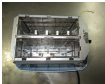
شکل ۶-۵۴ سیم اتصال زمین جدا شده از فیش
