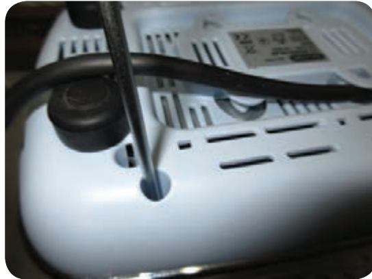
شکل ۶-۴۲ تشخیص نوع و محل پیچ‌های باز شده
