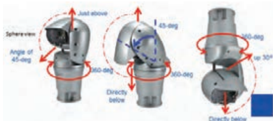
شکل ۳-۱۵- چند نمونه دوربین اسپید دام و زاویه چرخش آن
