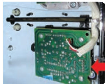
شکل ۶-۵۰ بُرد الکترونیکی شکل ۶-۵۱ محل اتصال سوکت به بُرد الکترونیکی شکل ۶-۵۲ سوکت از بُرد جدا شده است
