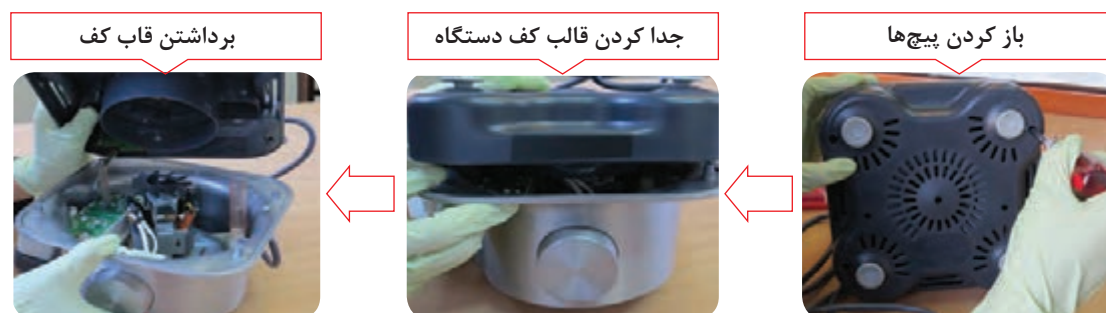
شکل ۲۲-۱. اینفوگرافی باز کردن کف دستگاه
