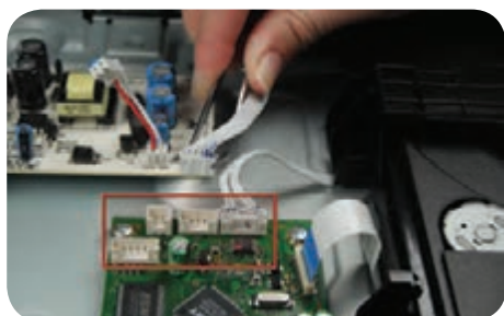
شکل ۶-۲۰ جدا شدن تمامی سوکت‌ها از برد
