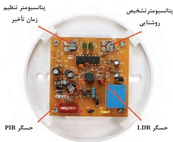
شکل ۲-۲۷- مدار داخلی یک نمونه حسگر سقفی
