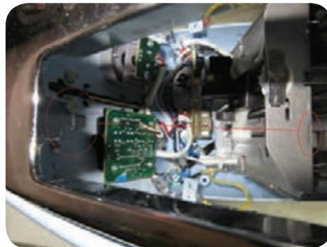
شکل ۵۷-۶ محل اتصال قسمت‌های فلزی
