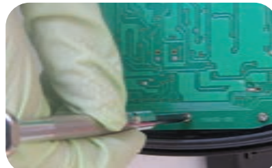
شکل ۱۶-۱ باز کردن پیچ‌های اتصال بدنه
