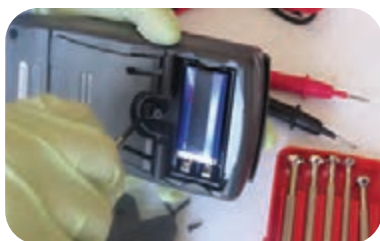
شکل ۱۴-۱ باز کردن پیچ‌ها و آزادسازی خارها
