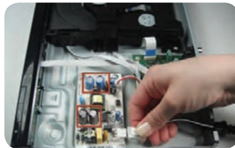
شکل ۶-۲۳ آزادکردن سوکت منبع تغذیه
