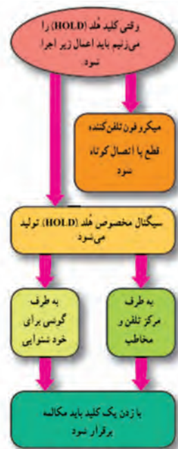
شکل ۳۲-۵- عملکرد مدار هلد
