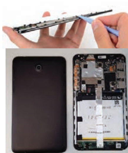
شکل ۵-۲۹ استفاده از کاردک برای جدا کردن قاب از بدنه
