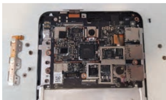
شکل ۵-۳۱ باز کردن پیچ‌های اتصال‌دهنده برد به بدنه
