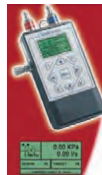
شکل ۲۴- چند نمونه دستگاه الکترونیکی اندازه گیری جریان
