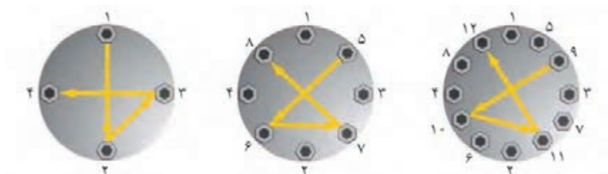
شکل ۲۳- ترتیب سفت کردن پیچ‌های فلنج
