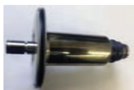
شکل ۱۱- روتور داخل محفظه فولادی
