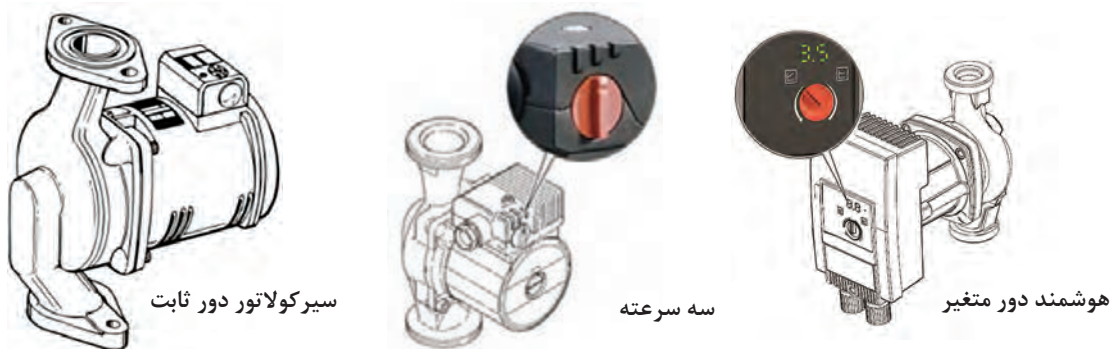
شکل ۴- قابلیت تغییر دور در سیرکولاتورها
