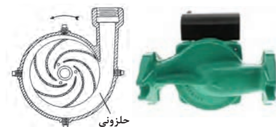
شکل ۷- پوسته حلزونی در پمپ خطی و زمینی
