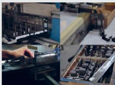
شکل ۱۰۲- خم کن با قطعات مختلف آن
