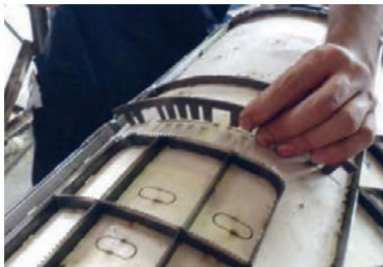
شکل ۱۳۳- قرار دادن تیغ‌ها در سیلندر
