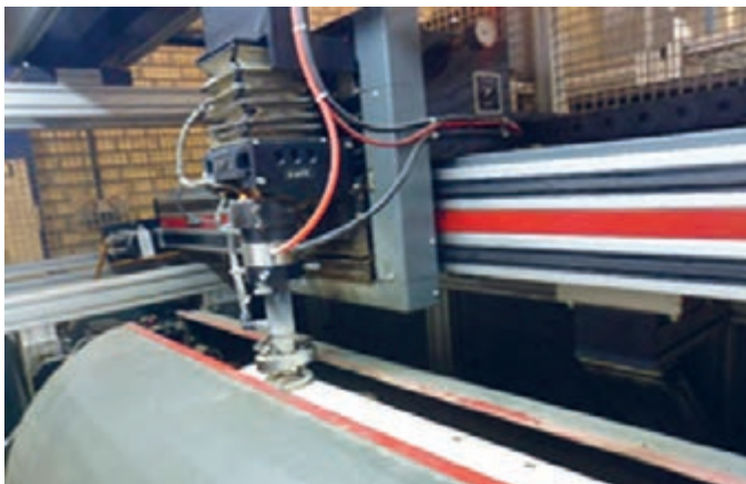
شکل ۱۲۵- دستگاه برش لیزری
