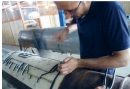
شکل ۱۳۴- جا زدن تیغ‌ها با چکش
