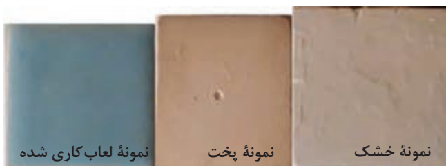
شکل ۱۲- تأثیر انقباض پخت بر ابعاد نمونه
