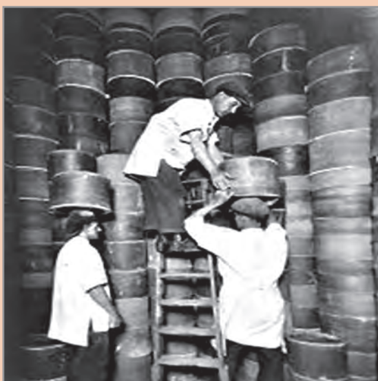
شکل ۶۷ - چیدمان ستونی ساگارها در کوره‌های سنتی
