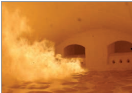
الف) مخزن ذوب کوره ریجنراتوری پشت گذر
