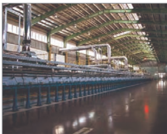
شکل ۳۰- گرمخانه تنش زدایی شیشه
