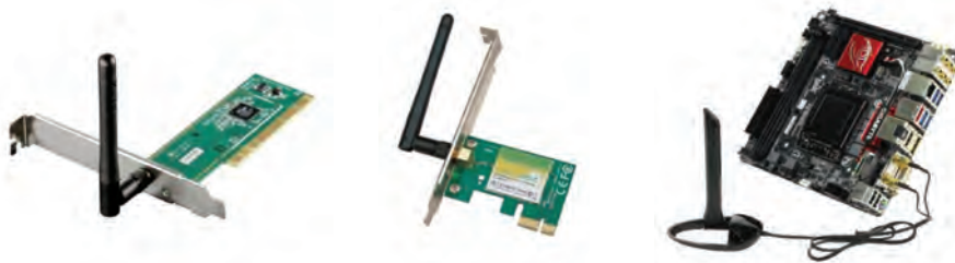
شکل ۵- کارت شبکه بی سیم داخلی
