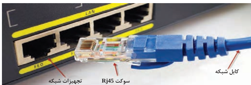
شکل ۶- اتصال سوکت Rj45 به تجهیزات شبکه
