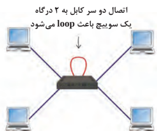
شکل ۵۹- وجود loop در سوییچ
