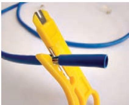
شکل ۲۵- لخت کردن سر کابل
