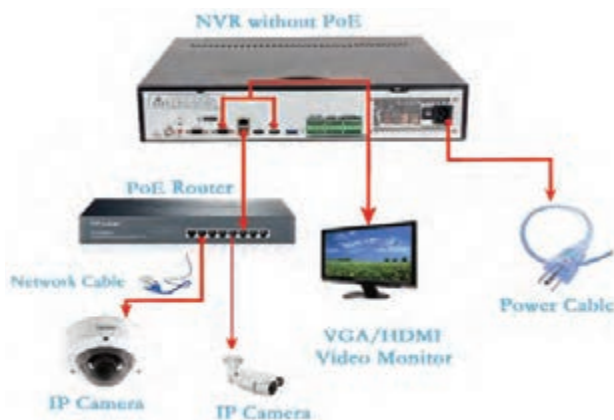
شکل ۱۷- اتصال دوربین به NVR
