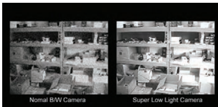
شکل ۱۸- تأثیر مشخصه Minimum Illumination در تصویر
