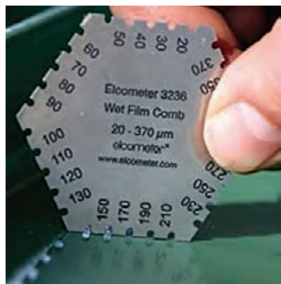
شکل ۱۹- شانه مخصوص اندازه‌گیری ضخامت فیلم تر رنگ
