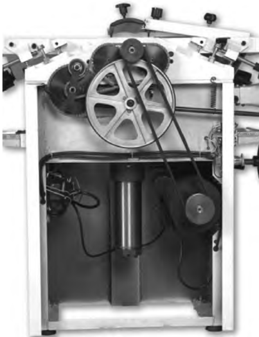
شکل ۵۱- بخش‌های مکانیکی یک ماشین گندگی که به روانکاری نیاز دارند
