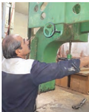
شکل ۱۷- خارج کردن تیغه از روی فلک‌های ماشین اره نواری
