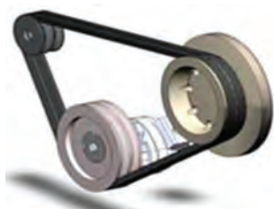
شکل ۵۳- نمونه‌ای از سیستم انتقال نیرو به صورت چرخ و تسمه
