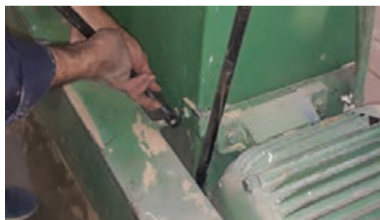
شکل ۵۹- روش باز کردن حفاظ و بررسی تسمه
