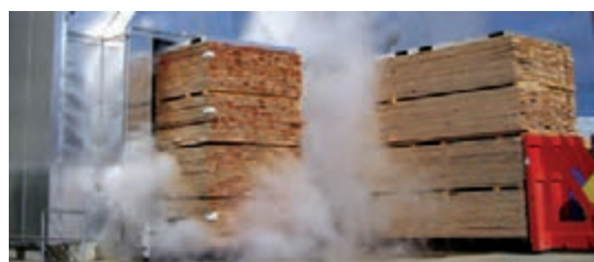
شکل ۶۴- اصول دسته‌بندی چوب روی واگن
