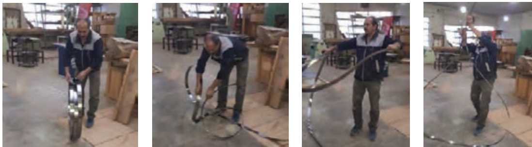
شکل ۱۹- روش جمع کردن تیغه اره نواری
