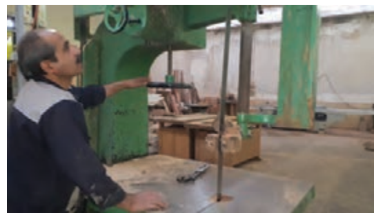
شکل ۱۶- شل کردن تیغه برای خروج و تعویض تیغه اره نواری
