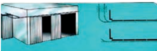
شکل ۳۲- در ریلی برای کوره‌های با پهنای تا ۱۳ متر
