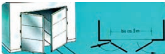
شکل ۳۰- در بادبزی تکی یا دوتایی برای کوره‌های کوچک با پهنای تا ۵ متر
