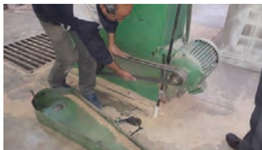
شکل ۵۹- روش باز کردن حفاظ و بررسی تسمه
