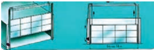
شکل ۳۳- در با حرکت عمودی برای کوره‌های بزرگ تا پهنای ۱۴ متر
