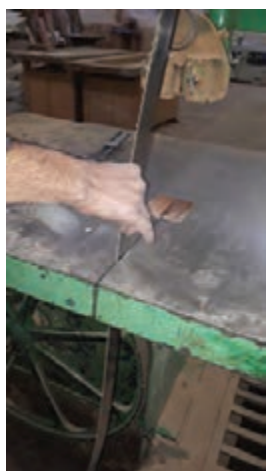
شکل ۱۷- خارج کردن تیغه از روی فلک‌های ماشین اره نواری
