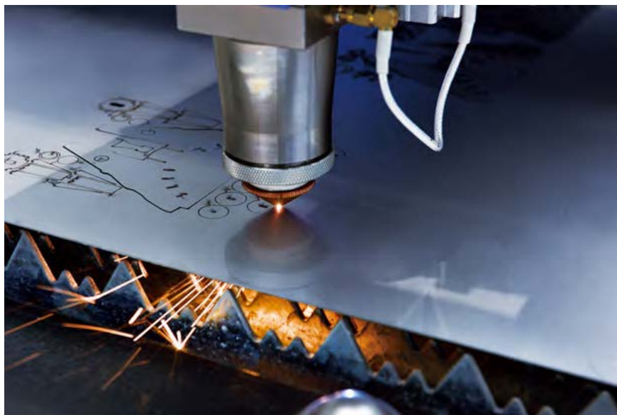
شکل ۱۹: برشکاری با پرتو لیزر
