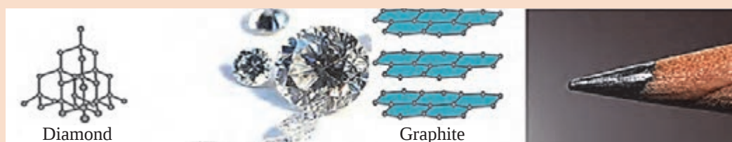
شکل ۲- ساختار گرافیت لایه ای و الماس شبکه ای
