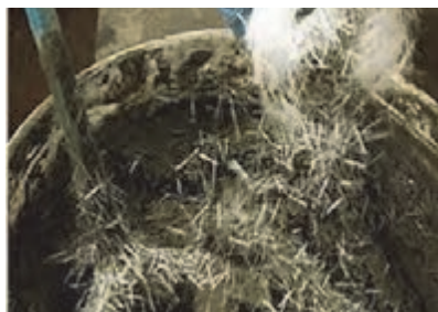
شکل ۱۸- استفاده از الیاف شیشه در مخلوط سیمان
