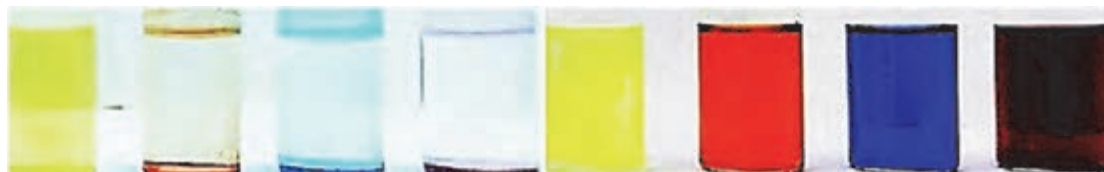
شکل ۲۱- کاهش شدت رنگ در پساب رنگ‌زا قبل و بعد از استفاده از نانو جاذب‌ها
