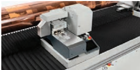
دستگاه در حال غلتک‌سازی
