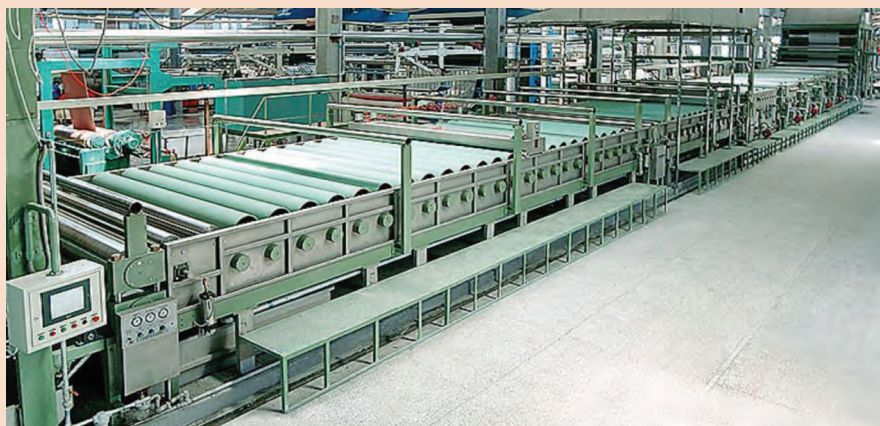
شکل ۱۲- نمایی از ماشین مرسریزاسیون غلتکی بدون زنجیر
