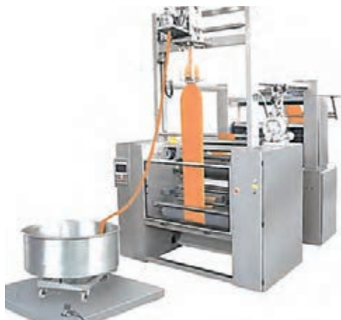
شکل ۱۴- تصویر یک آبگیر - تاب‌گیر بالنی
