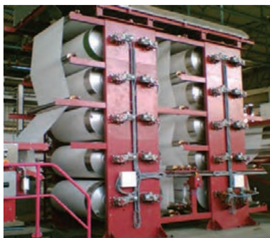
شکل ۱۵- تصویر خشک‌کن سیلندری یا غلتکی عمودی
