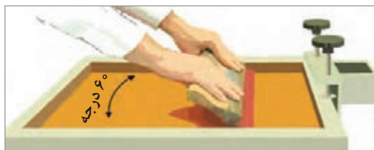
شکل ۱۶- نحوه کشیدن راکل به روش دستی
