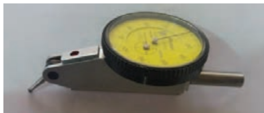
شکل ۱۶- ساعت حساس (شیطانکی) برای کنترل دایره ای بودن
