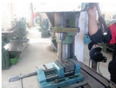
شکل ۱۳- نصب برقوروی محور دستگاه مته
