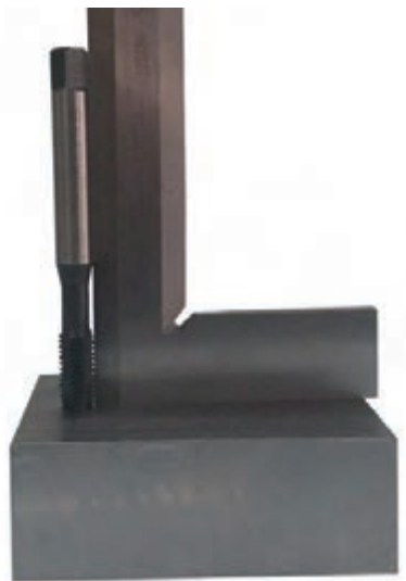
شکل ۷- کنترل عمود بودن قلاویز با سوراخ
