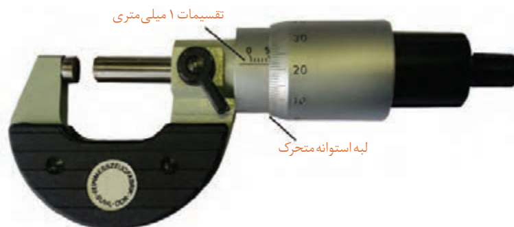
شکل ۳- میکرومتر با استوانه متحرک ۱۰۰ قسمتی
