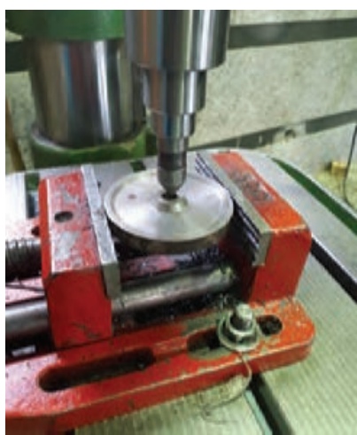
شکل ۹- استفاده از مرغک در ایجاد هم‌مرکزی صحیح
