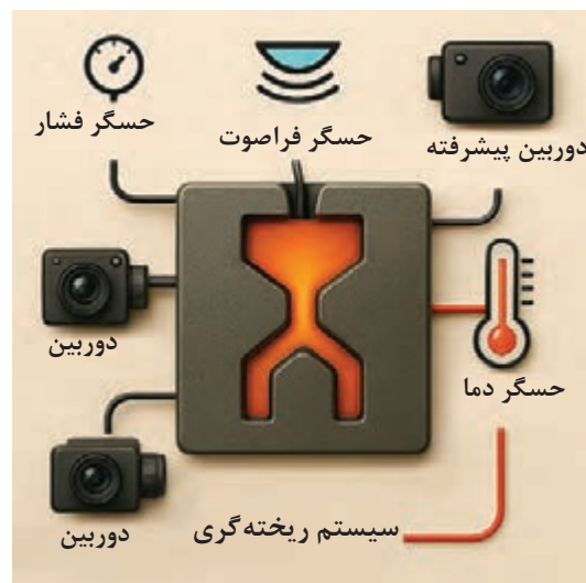
شکل ۴۲- تصویر شماتیک یک سیستم ریخته‌گری با حسگرهای متفاوت
