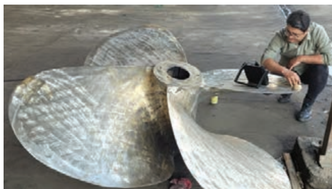
شکل ۲۵- آزمون امواج فرا صوت روی پروانه ریخته‌گری شده کشتی از جنس برنز
