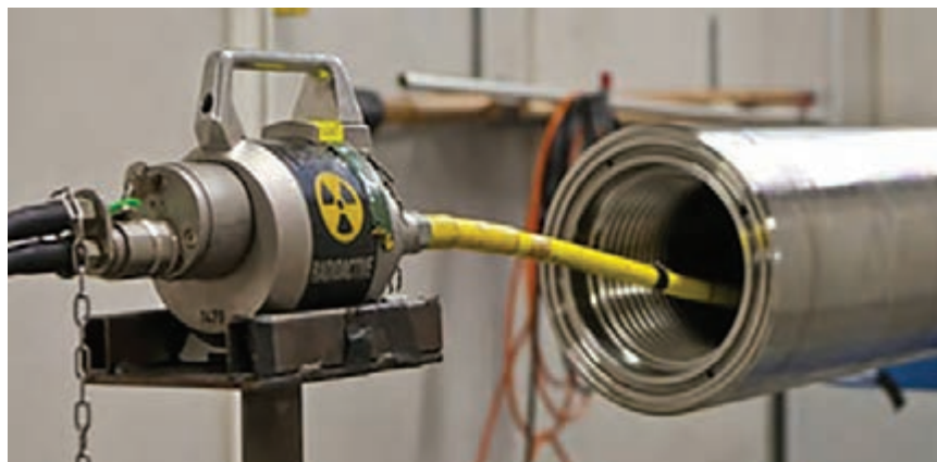
شکل ۳۱- مخزن سربی و شلنگ‌های کنترلی ماده رادیواکتیو و تولید پرتو گاما
