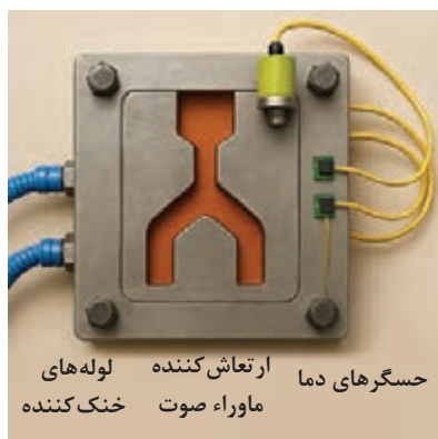
شکل ۴۰- تصویر شماتیک یک قالب هوشمند
