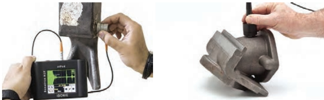
شکل ۲۴- انجام آزمون امواج فرا صوت روی قطعه ریختگی
