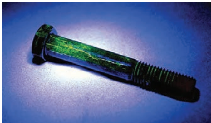
شکل ۱۸- آزمون فلورسنت ذرات مغناطیسی به روش سیم‌پیچ
