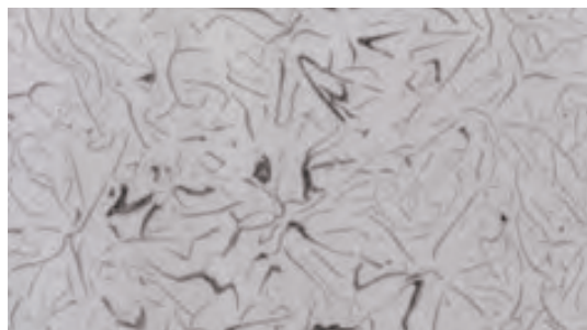
شکل ۳۳- ساختار چدن هیپریوتکتیک (فریت به همراه گرافیت لایه‌ای)
