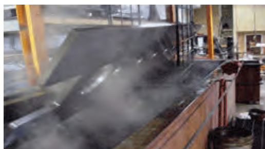
شکل ۲۰- عملیات سیاه کاری
