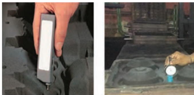
شکل ۲۷- نحوه اندازه گیری استحکام قالب با استحکام سنج عقربه‌ای و دیجیتالی
