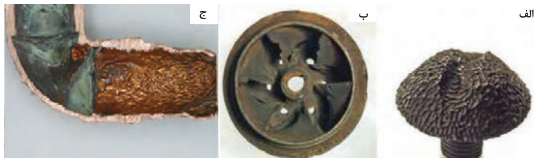
شکل ۱۰- (الف) پیچ در محلول خورنده حاوی ذرات ساینده دچار خوردگی فرسایشی شده است. (ب) پره پمپ به دلیل قرار گرفتن در محلول خورنده حاوی ذرات ماسه دچار خوردگی فرسایشی شده است. (ج) لوله فولادی که در اثر وجود سیال داخل آن دچار خوردگی فرسایشی شده است.
