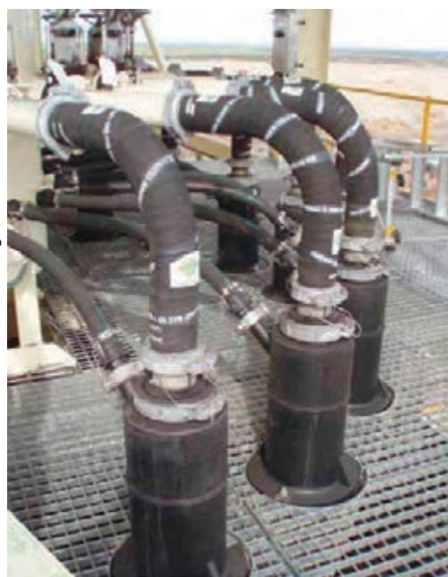
شکل ۲۲- جت‌های تزریق پالپ در سلول فلوتاسیون جیمسون
