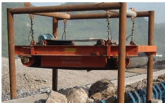
شکل ۲۶- جدا کننده های مغناطیسی معلق نوار متقاطع
