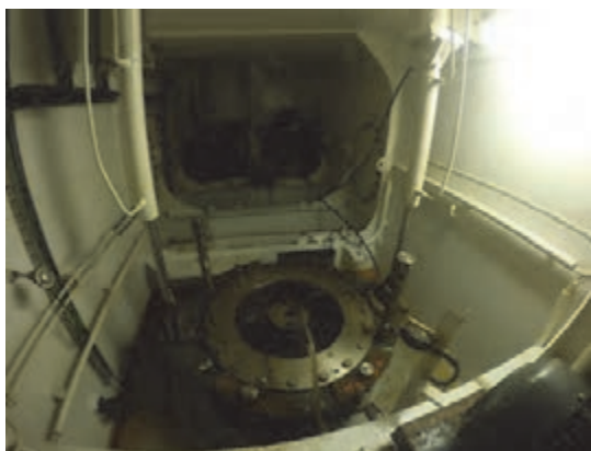
شکل ۲۷- چند نمونه مبدل (ترانسدیوسر) به کاررفته در این نوع سرعت‌سنج و محل قرارگیری فرستنده آن در کف کشتی
