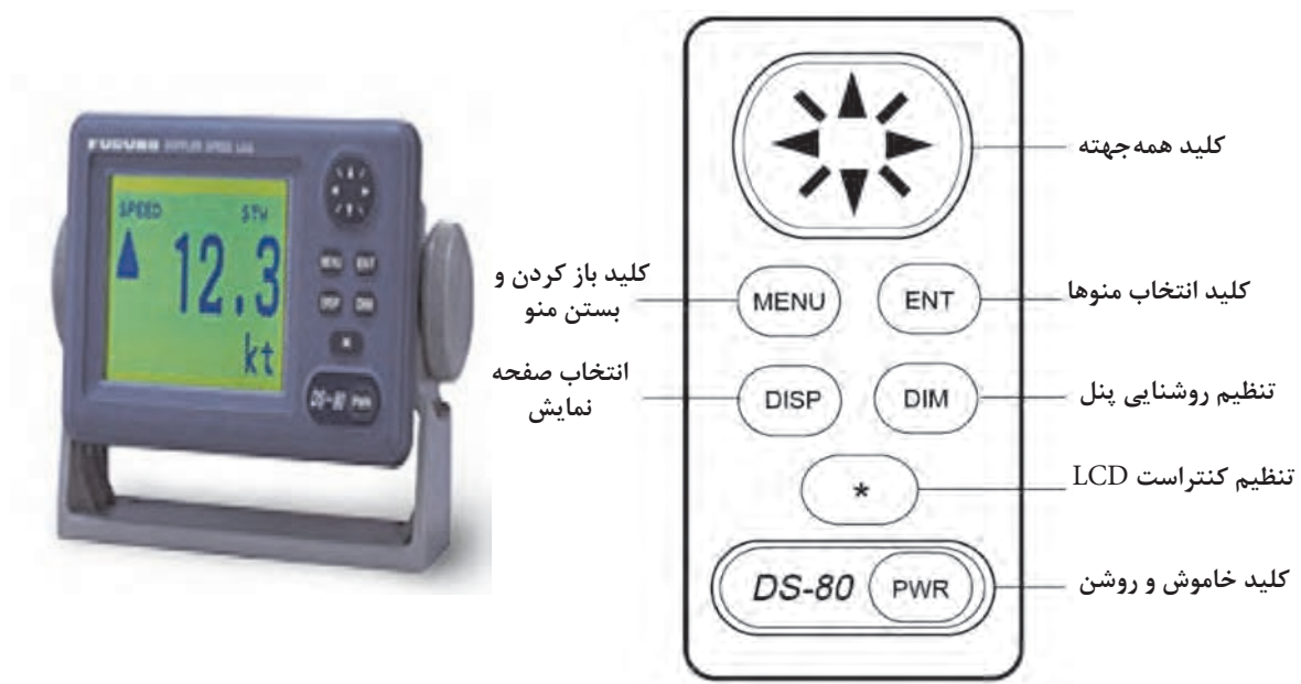
شکل ۳۱- نمای کلی کلیدهای کنترل سیستم سرعت سنج
