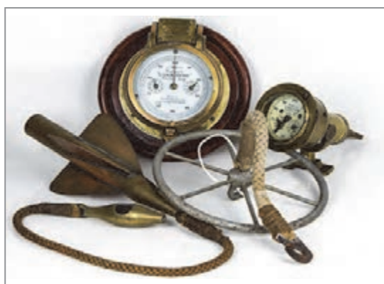
شکل ۲۲- سرعت سنج چرخنده یا ثبت کننده
