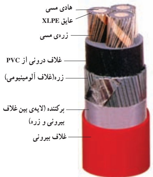
شکل ۴-۳۹- کابل با غلاف آلومینیومی
