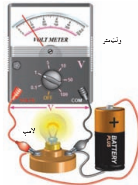
شکل ۱۰-۹- ولت متر در مدارات به صورت موازی با مصرف کننده قرار می‌گیرد.
