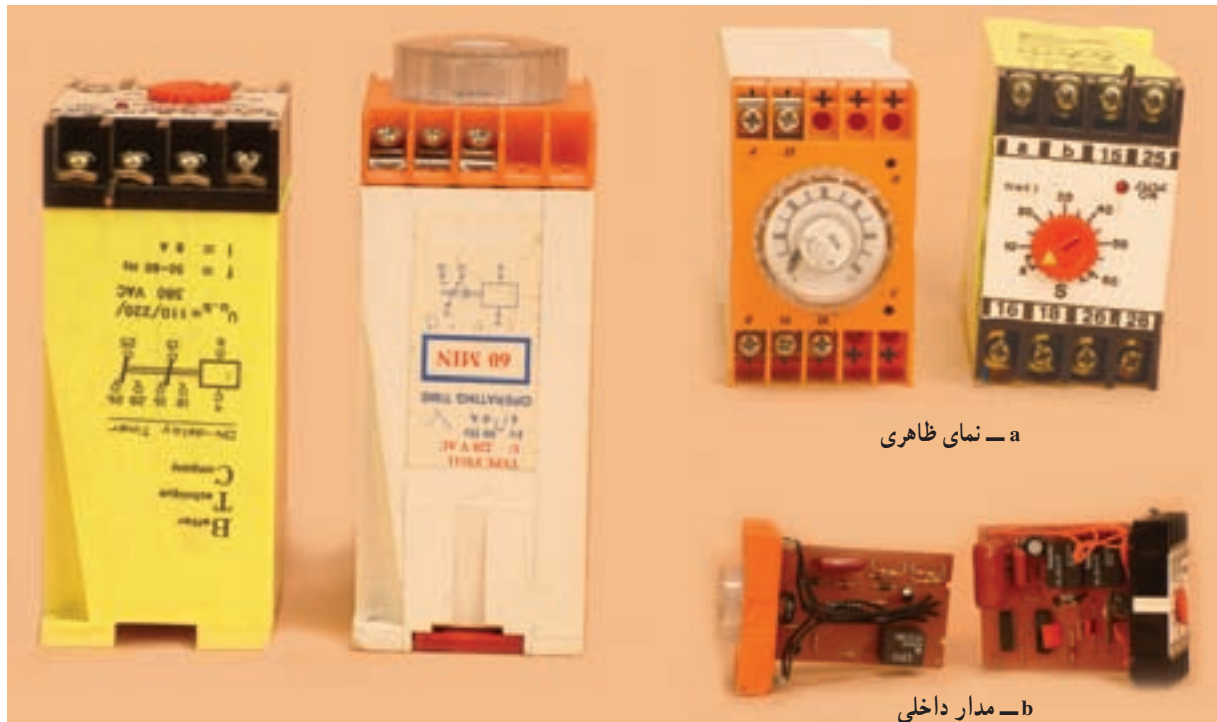
شکل ۸-۲۳- نمای ظاهری و مدار داخلی تایمر الکترونیکی
