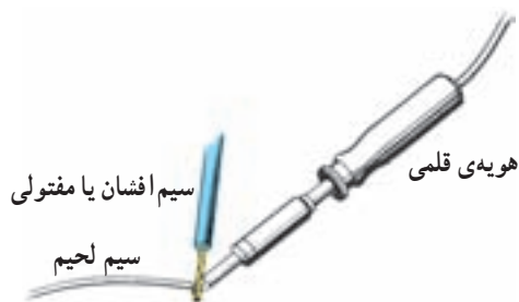
شکل ۲۹-۴- اصول صحیح قلع اندود کردن سرسیم
