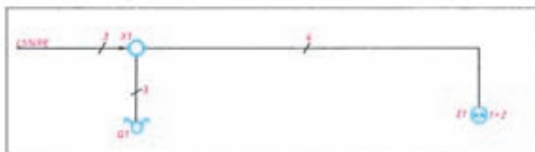
شمای فنی مدار کلید دوپل
