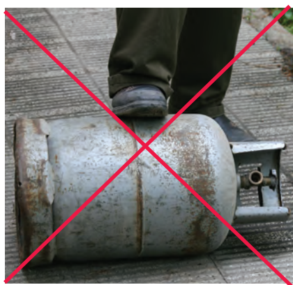
شکل ۱-۶۹ حمل و نقل نادرست کپسول گاز مایع
