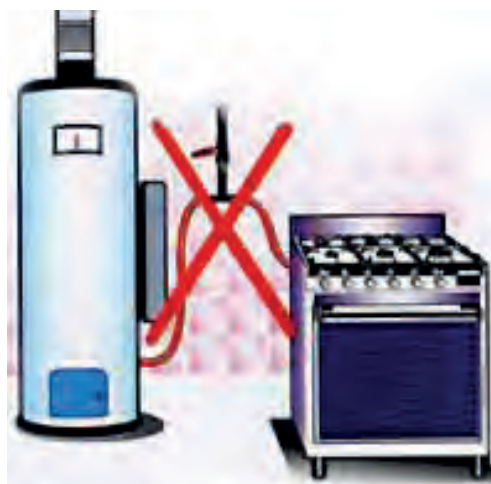
شکل ۳-۹ نصب نادرست آب گرم کن زمینی به جای آب گرم کن دیواری
