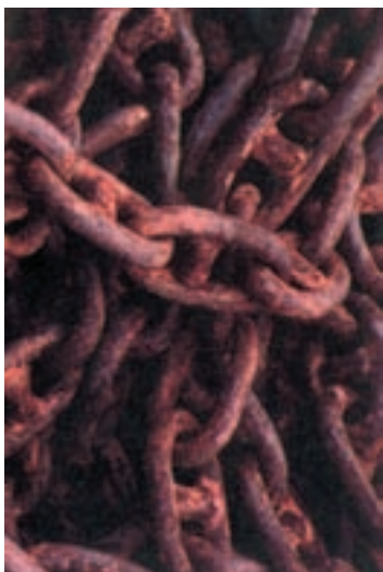
زنگ زدن آهن. یک تغییر شیمیایی آهسته!
