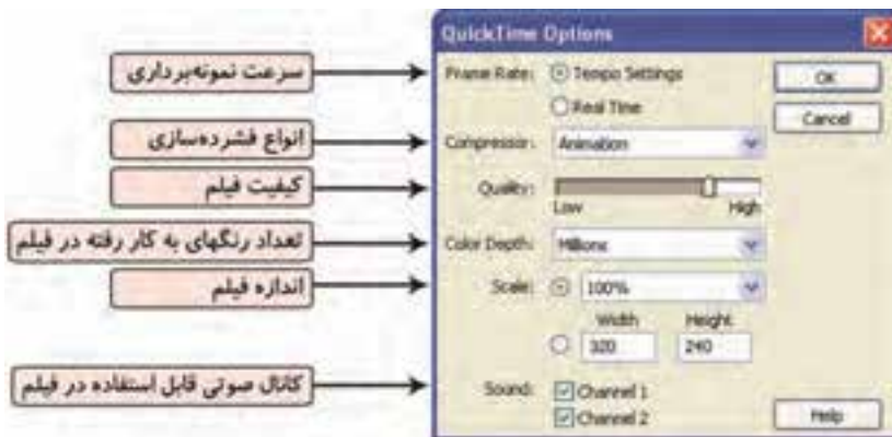
شکل ۱۲-۱۳ تعیین تنظیمات خروجی MOV
