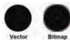
شکل ۵-۱ مقایسه بزرگنمایی تصویر برداری و نقشه بیتی
