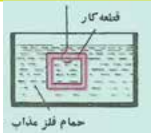
شکل ۷-۸: غوطه‌وری در فلز مذاب
