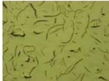
الف ب شکل ۳-۴- هرچه لایه‌های گرافیت بیشتر و ضخیم‌تر باشند، استحکام چدن کاهش می‌یابد. استحکام چدن (ب) از (الف) کمتر است.
