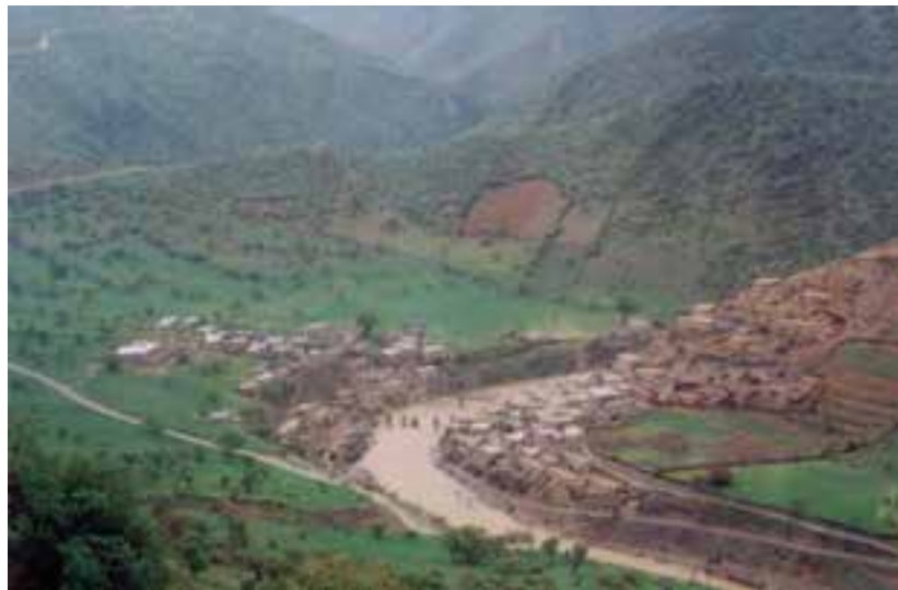
شکل ۳۸-۱- عدم رعایت حریم رودخانه و خطر سیل
