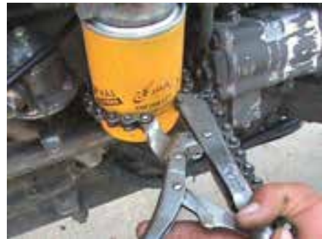
شکل ۳۴-۴ تعویض صافی روغن
