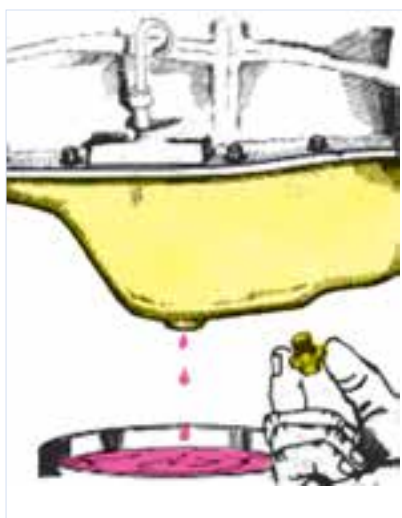
شکل ۳۳ - ۴ تخلیه روغن موتور
