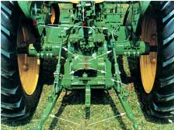
شکل ۳-۳- اجزای مالبند اتصال سه نقطه (در تراکتور JD ۳۱۴۰)
