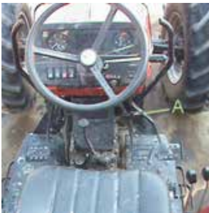
شکل ۲-۲ جفت کن پدال ترمز در تراکتور
