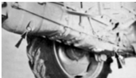
شکل ۳۲-۶ پیچ‌های تخلیه روغن هیدرولیک تراکتور MF 285
