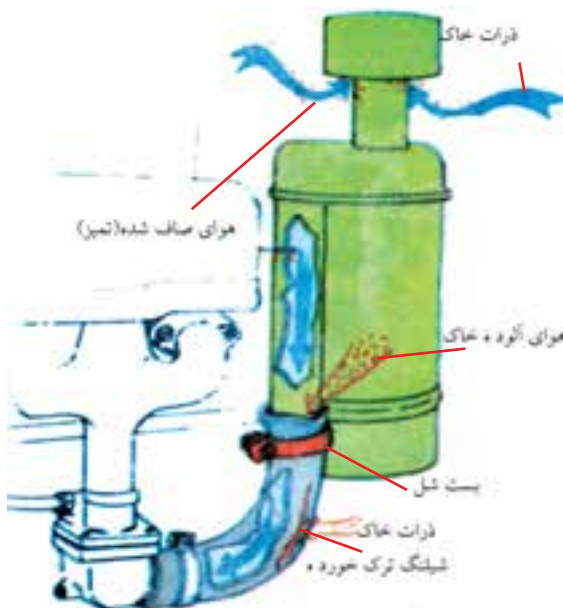
شکل ۴-۵ عوامل کاهش کارایی صافی
