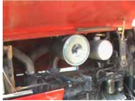
شکل ۷-۴ تمیز کردن خاکدان ۴- قسمت داخلی بدنه صافی را با پارچه تمیز کنید (شکل ۸-۴). خاک
