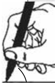
شکل ۳-۱۳ زاویه ی قلم کمتر از ۸۰ درجه نباشد.
