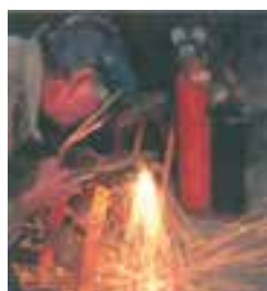
شکل ۵ برشکاری با اتین
