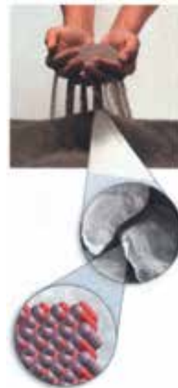
سیلیس و سیلیکات‌ها سازندهٔ اصلی خاک و سنگ بوده و دارای پل‌های Si - O - Si هستند.
