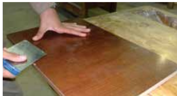
شکل ۱۴-۱۴۱- برداشتن اضافه نوار با لیسه.
