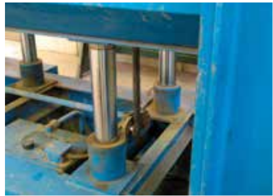
شکل ۳۳-۱۵- حرکت همزمان و متعادل سیلندرها توسط چرخ دنده پرس.
