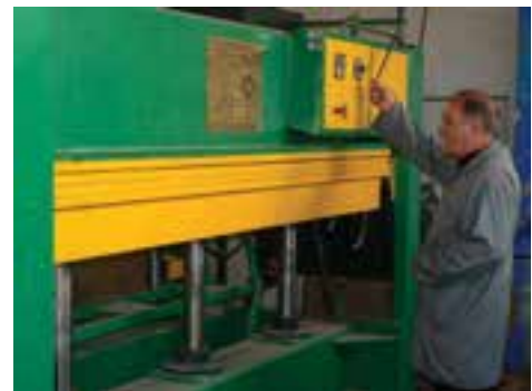
شکل ۲۰۸-۱۵- یکنواخت بسته شدن پرس.
