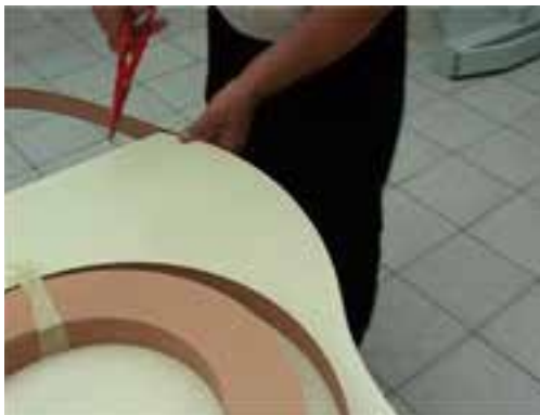
شکل ۱۰۳-۱۶- قطع کردن نوار لبه‌چسبان با قیچی.
