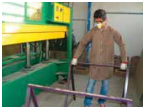
شکل ۷۵-۱۵- استقرار فرپای دوم به فاصله مناسب طول صفحه.
