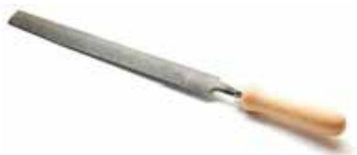
شکل ۹-۱۲ تیغه، دنباله و دسته چوبسآء.
