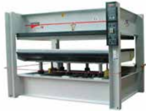
شکل ۱۳۹-۱۵- جک‌های هیدرولیک مجهز به سیلندر و پیستون.
