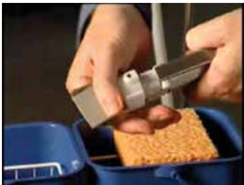
شکل ۸۸-۱۵- شستشوی تیغه چسب‌زن دستی پنوماتیک.
