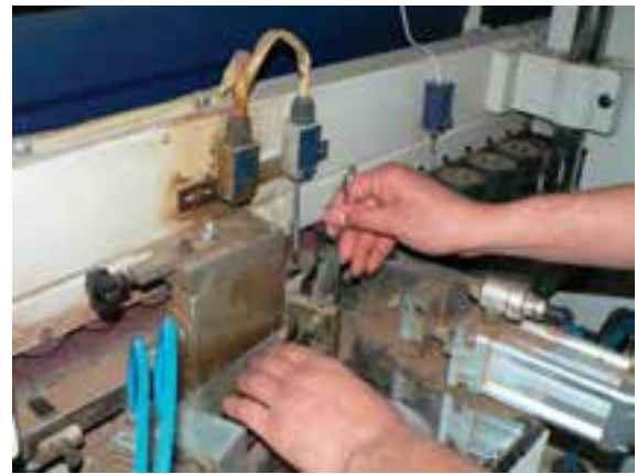
شکل ۱۷۰-۱۶- میکروسوئیچ فتری عمودی در ایستگاه غلطک چسب.
