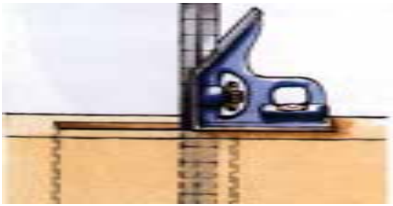
شکل ۲۲-۷- علامت‌گذاری و فطاکشی با سوزن فطاکشی.
