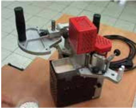
شکل ۹۹-۱۶- مخزن چسب گرانول و پیچ تنظیم چسب.
