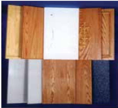
شکل ۳۹-۱۶- انواع صفحات روکش و لبه چسبانی شده.
