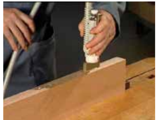
شکل ۴۵-۱۶. اتصال شیلنگ چسب به دستگاه چسب‌زن پنوماتیک.
