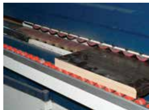
شکل ۱۸۷-۱۶- لبه چسبانی قطعات قوس دار.
