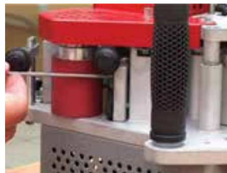
شکل ۱۰۶-۱۶- تنظیم ضخامت نوار با پیچ گوشتی.
