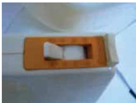
شکل ۴۸-۱۵. کلید روشن و خاموش کردن و تنظیم دور دستگاه همزن برقی.
