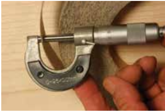
شکل ۱۲۵-۱۶- اندازه‌گیری ضخامت نوار با میکرومتر.
