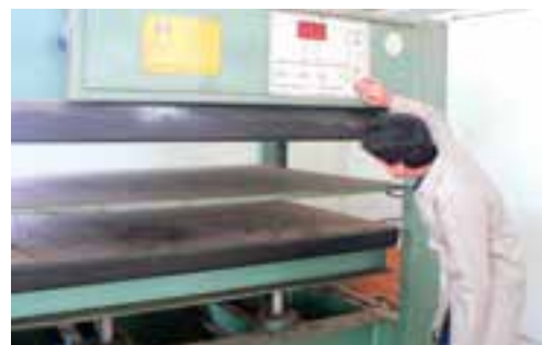
شکل ۱۸۱-۱۵- کلید پایین آمدن صفحه پرس برقی.
