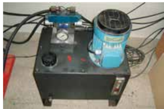
شکل ۲۱-۱۵- کارتر روغن مجهز به الکتروپمپ و دریاچه شفاف سطح روغن.
