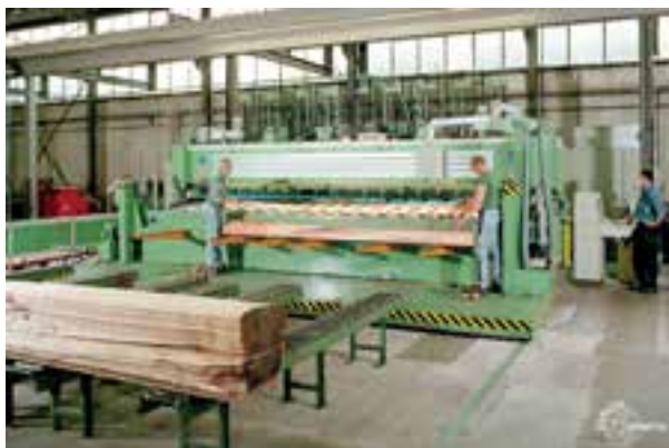
شکل ۶-۱۷- دستگاه تهیه (روکش به روش کاردی).
