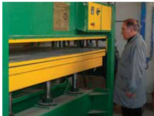
شکل ۱۸۴-۱۵- صفمه پرس تا روی توپی لاستیکی پایین می‌آید.
