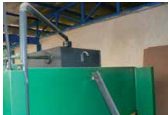
شکل ۱۴۴-۱۵. کارتر روغن در بالای پرس (روغنی).
