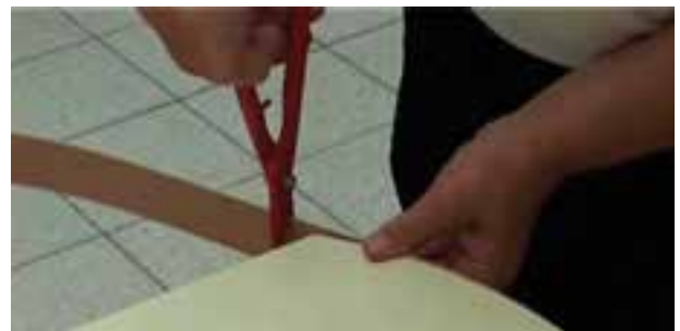
شکل ۱۶-۶۳- نوار لبه چسبانی را با قیچی قطع نمایید.
