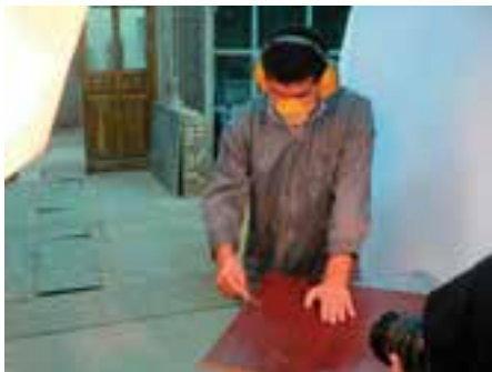
شکل ۲۱۱-۱۶- رعایت حفاظت کار با کاتر.
