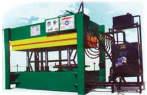
شکل ۴۲-۱۵. پرس هیدرولیک با سیستم استفاده از روغن داغ در صفحات.
