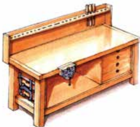
شکل ۶-۶- میز کار یک طرفه با گیره کتابی.
