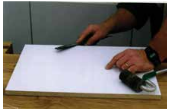
شکل ۸۱-۱۶- برطرف کردن تیز لبه صفحه با سوهان نرم.
