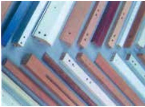
شکل ۵-۴- مقاوم کردن فیبر برای تامل اتصالات میغ و پیچ و...
