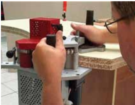
شکل ۱۰۷-۱۶- استقرار دستگاه (روی ضخامت صفحه کار).
