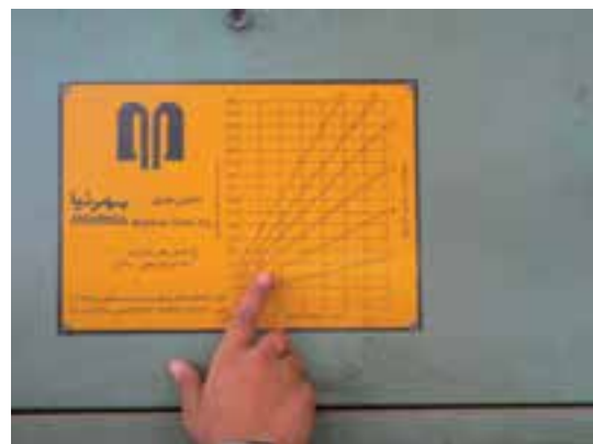
شکل ۱۳۲-۱۵- دیاگرام منمنی تنظیم فشار پرس برقی.
