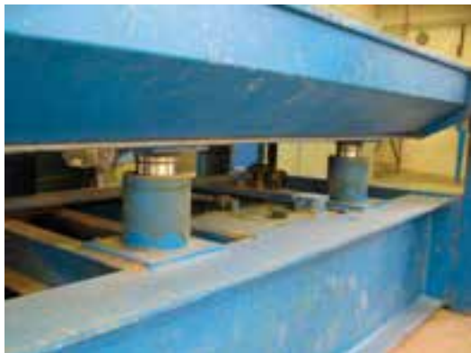
شکل ۳۲-۱۵- سیلندر و پیستون جک‌های پرس هیدرولیک.
