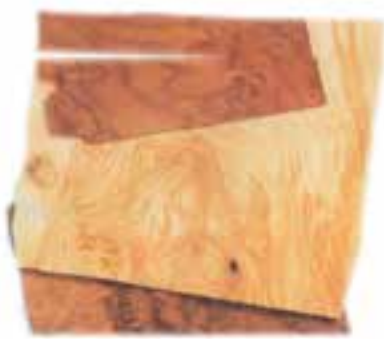
شکل ۵-۱۵ سه نوع روکش طبیعی.
