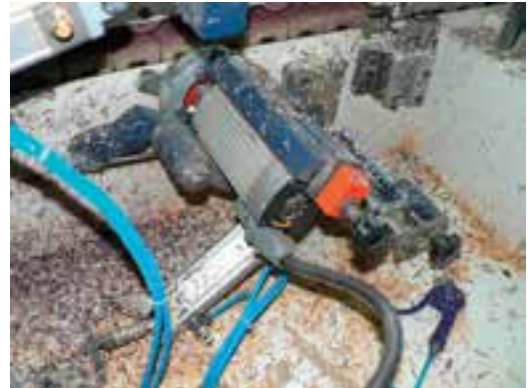
شکل ۱۷۴-۱۶- تنظیم تویی فرز پرداخت لبه نوار.
