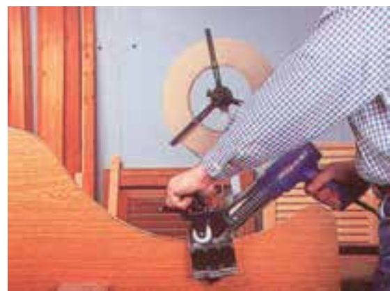
شکل ۷۰-۱۶- نوار چسبانی با لبه چسبان غلطکی دستی.
