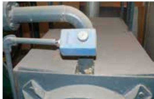
شکل ۱۲۹-۱۵. حرارت سنج (روی دیگ روغن پرس روغنی).
