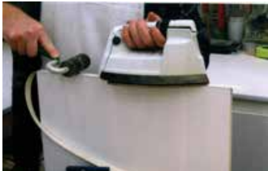
شکل ۶۱-۱۶- لبه چسبانی نوار PVC با اطو.
