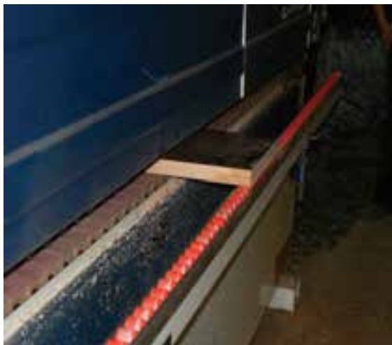
شکل ۱۶۹-۱۶- مرکت قطعه کار و برافروزدن به میکروسوئیچ داخل ماشین.
