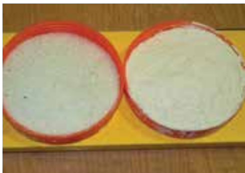
شکل ۵۹-۱۵- پودر چسب اوره فرم آلدئید و کلرور آمونیم (سفت کننده).
