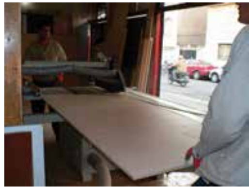
شکل ۱۵۵-۱۶ برشکاری ورق کامل M.D.F دو نفره.
