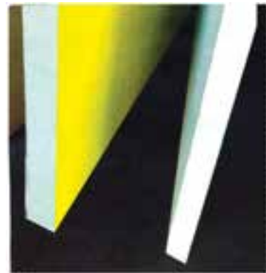
شکل ۱۰۱-۱۵. PVC اسفنجی سفت جایگزین M.D.F.
