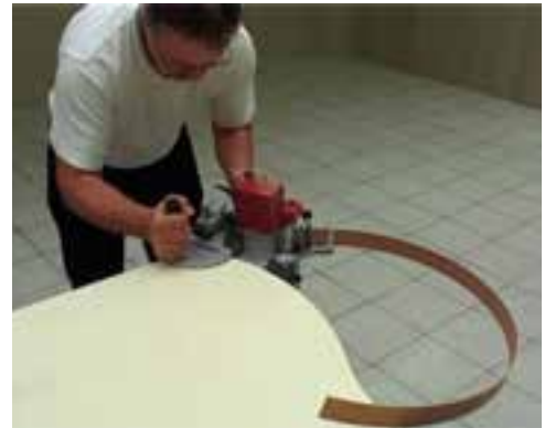
شکل ۱۰۸-۱۶. لبه چسبانی با دستگاه قوسی.
