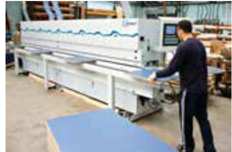
شکل ۲۱۲-۱۶- لبه چسبان اتوماتیک مفاظت شده.
