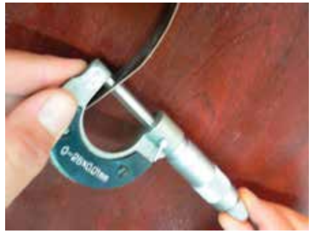
شکل ۳-۸. میکرومتر با میدان اندازه‌گیری (۰ - ۲۵) میلی‌متر.
