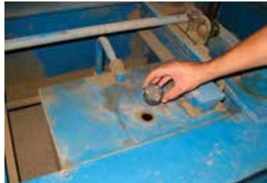
شکل ۲۰-۱۵- باز کردن دریاچه کارتر روغن.
