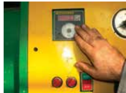
شکل ۱۷۴-۱۵- تنظیم گیج حرارت صفحات پرس.
