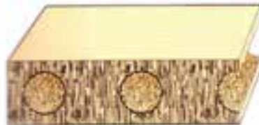
تخته خرده چوب ساخته شده با پرس اگستروجر و معیوف (وکیوم)
