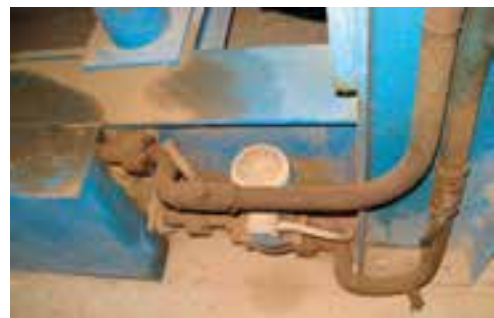
شکل ۱۸۲-۱۵- اهرم برگشت روغن در پرس (روغنی).
