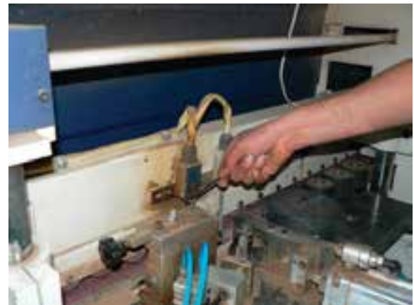
شکل ۱۷۱-۱۶- تنظیم میکروسوئیچ هدایت اولیه نوار.
