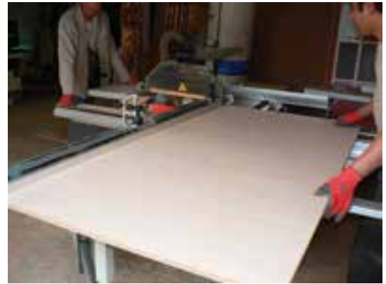
شکل ۱۴۵-۱۶- برش M.D.F در کارگاه لبه چسبانی.
