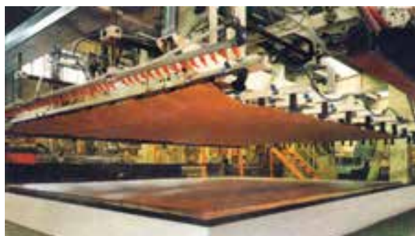
شکل ۱۰۹-۱۵- استقرار ورق ملامینه روی صفحات.
