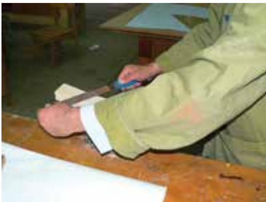
شکل ۸-۹- طریقه به دست گرفتن و اعمال نیرو در سوهانکاری.
