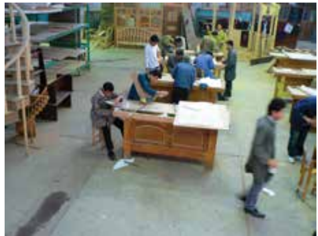
شکل ۳-۶- میز کار (کارگاهی ۴ طرفه).
