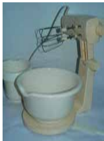
شکل ۵۴-۱۵- بلند کردن پروانه‌ها برای خروج مخزن چوب.
