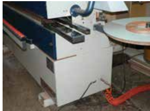
شکل ۱۷۸-۱۶- دهانه و روی صفحه کار برای لبه‌چسبانی.
