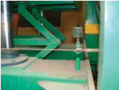
شکل ۱۴۵-۱۵. اهرم‌ها با توپی لاستیکی مقر صفحه پرس.
