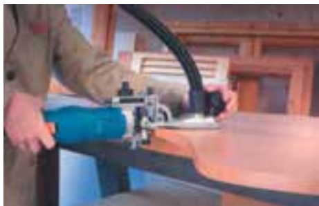
شکل ۸۶-۱۶. پرداخت لبه قوسی به صورت افقی.
