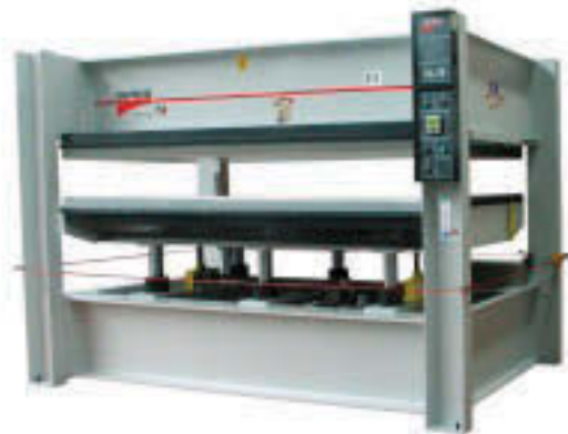
شکل ۲۰۶-۱۵- سیم قطع برق اضطراری پرس.
