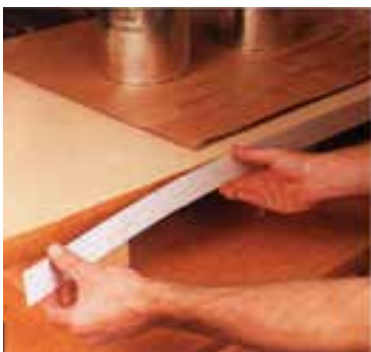
شکل ۱۶-۶۵- استقرار دقیق نوار لبه چسبان (وی چسب).
