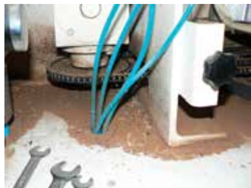
شکل ۲۰۱-۱۶- روغن کاری مومرها و چرخ زنجیرها.
