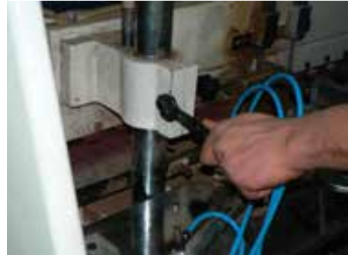
شکل ۱۸۲-۱۶. شل کردن بست ستون استقرار قسمت فوقانی.
