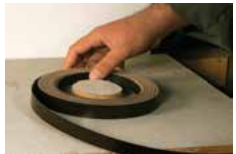
شکل ۱۳۱-۱۶- استقرار نوار در مقر میز تمک لبه چسبان.
