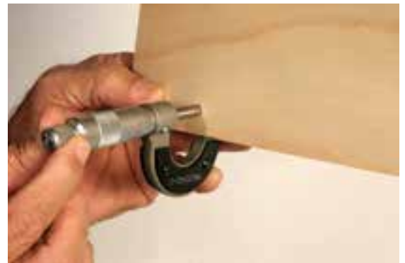
شکل ۱۶۰-۱۶. اندازه‌گیری ضخامت روکش با میکرومتر.
