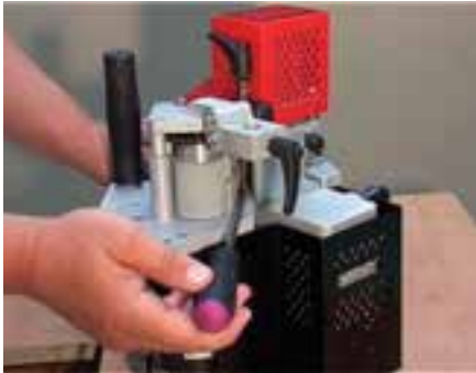
شکل ۱۶-۱۲۰- باز کردن پیچ تنظیم چسب.
