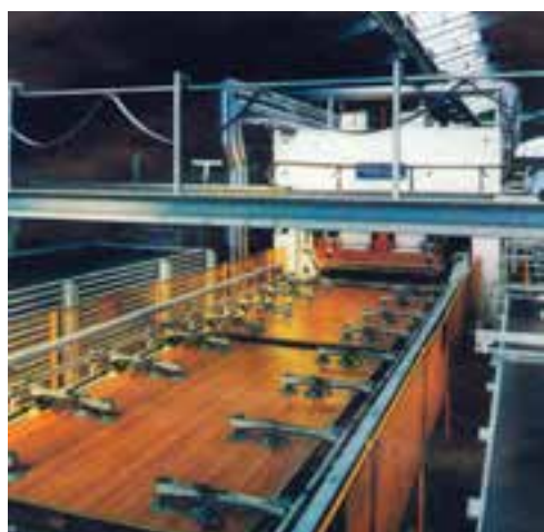
شکل ۱۰۸-۱۵- پرس ملامینه روی M.D.F و H.D.F و نئوپان.
