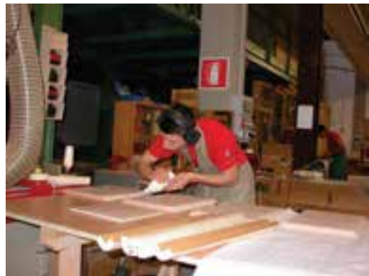
شکل ۴۹-۱۶- چسب زدن به ضخامت صفحات.
