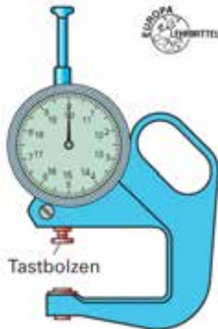
شکل ۱۵۷-۱۵. وسیله کنترل ضخامت صفحات قبل از پرسکاری.
