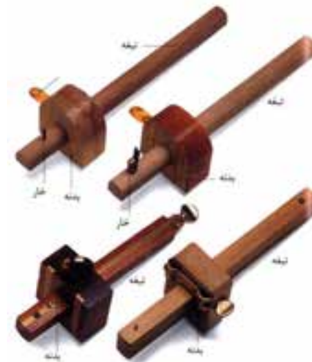
شکل ۹-۷- چهار نوع فماتکش تیره‌دار چوبی.
