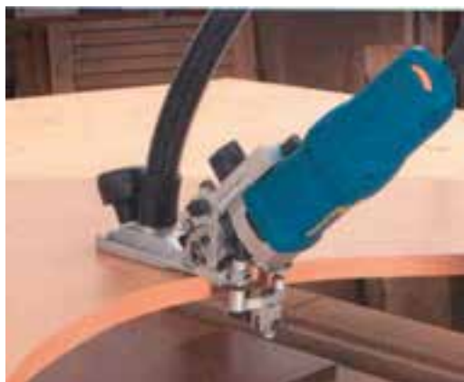
شکل ۸۷-۱۶. پرداخت لبه قوسی با زاویه.
