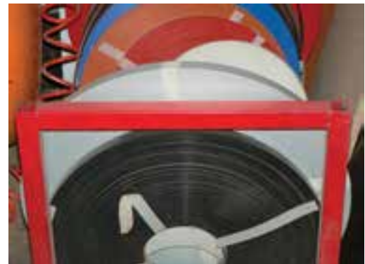
شکل ۶۷-۱۶ نوار ملامینه به عرض ۱۹ تا ۳۶ میلیمتر.
