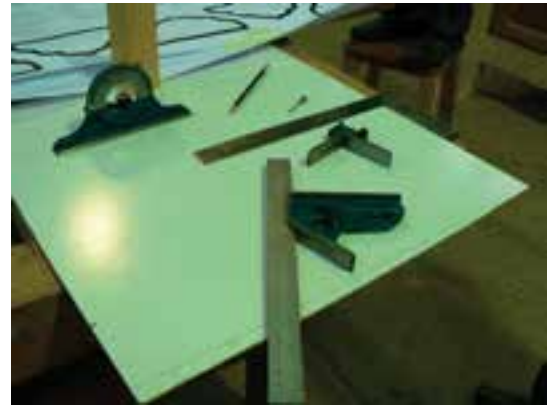
شکل ۱۰-۸- گونیای مرکب و اجزاء آن.
