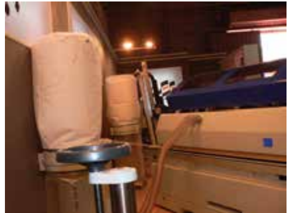
شکل ۱۴۹-۱۶- مکنده متمرک متصل به ماشین لبه‌چسبان.
