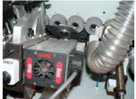
شکل ۱۹۰-۱۶. تیغه فرز گوشه در لبه چسبان اتوماتیک.
