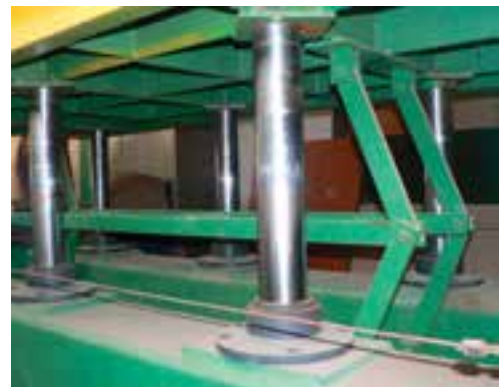
شکل ۱۴۸-۱۵- جک و سیلندرهای زیر پرس.
