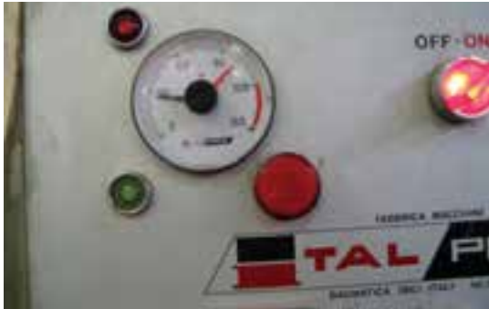
شکل ۱۳۱-۱۵. گیج تنظیم حرارت یک پرس برقی.
