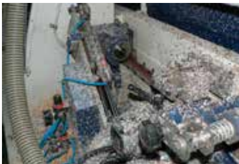
شکل ۱۶-۱۹۹- نیروی مکنده برای مکش ضایعات کافی نبوده.
