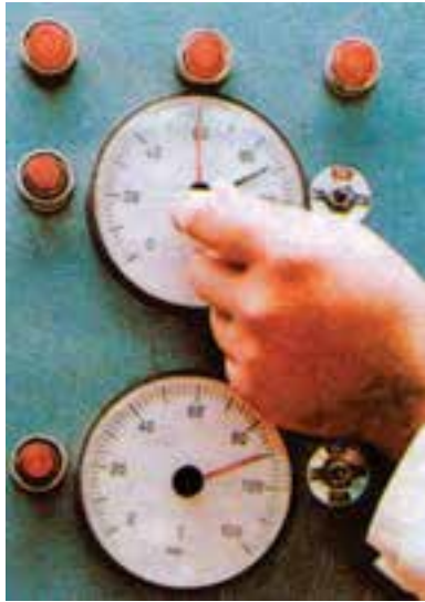
شکل ۱۷۵-۱۵- تنظیم گیج‌های حرارت پرس برقی.
