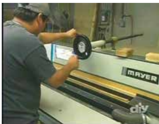
شکل ۹-۱۵. اندازه‌بری و درز کردن (روکش با ماشین اره روکش‌بر).
