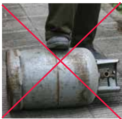
شکل ۶۹-۱ حمل و نقل نادرست کپسول گاز مایع
