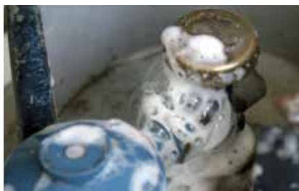
شکل ۶۷-۱ پ آزمایش گازبندی محل اتصال رگولاتور به کپسول و شیلنگ
