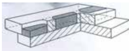
جوش دکمه‌ای (لوبیایی شکل)
