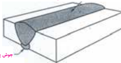
جوش شیاری بعد از جوشکاری طرف دیگر انجام شده
