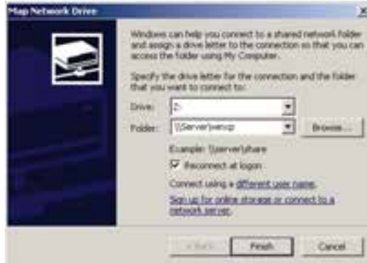
شکل ۴۴-۱ انتخاب درایو مجازی در کادر Drive و تعیین مسیر پوشه‌ی آن در کادر Folder
