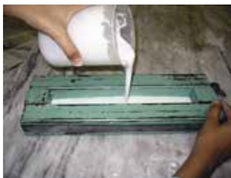
شکل ۲-۱۴- تخلیه دوغاب گچ داخل قالب
