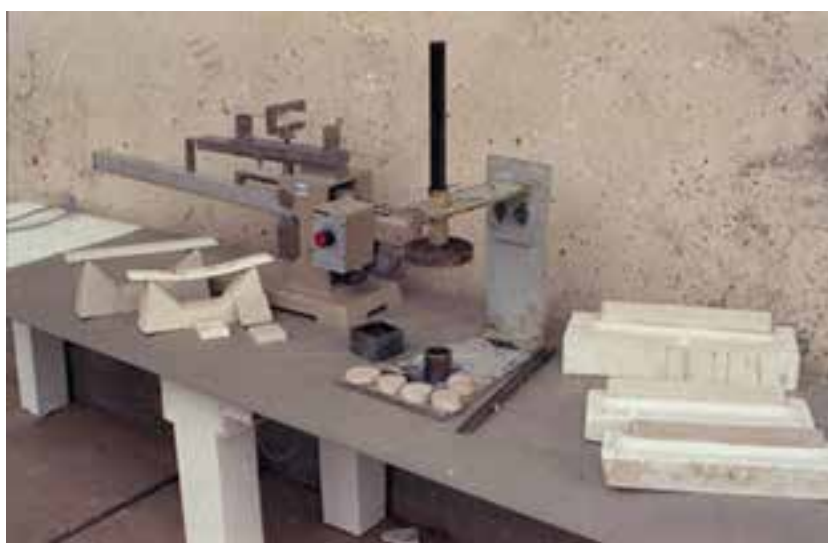
شکل ۳-۳- دستگاه های ففر کورن ، استحکام سنج ، قالب ساخت نمونه انقباض و برخی ابزار ویژه تست های فیزیکی
