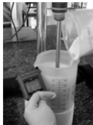
شكل ۲-۷- همزدن دوغاب گچ
