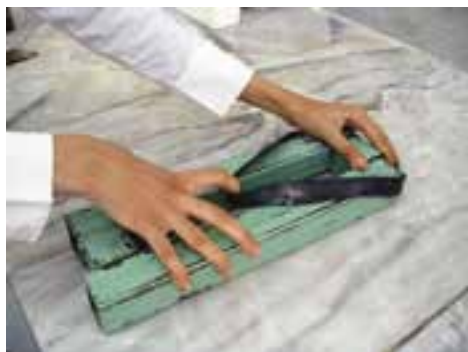
شکل ۲-۱۳- بستن قالب با نوار لاستیکی
