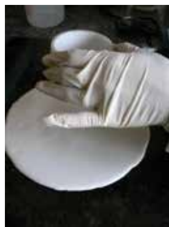
شکل ۲-۵- ب- بلند نمودن حلقه ویکات و جریان یافتن دوغاب گچ شکل ۲-۶- اندازه گیری قطر (سیالیت) دوغاب گچ جریان یافته
