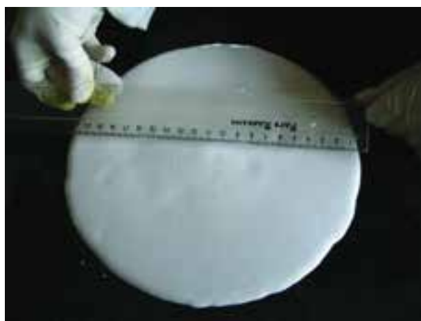
شکل ۲-۵- ب- بلند نمودن حلقه ویکات و جریان یافتن دوغاب گچ شکل ۲-۶- اندازه گیری قطر (سیالیت) دوغاب گچ جریان یافته
