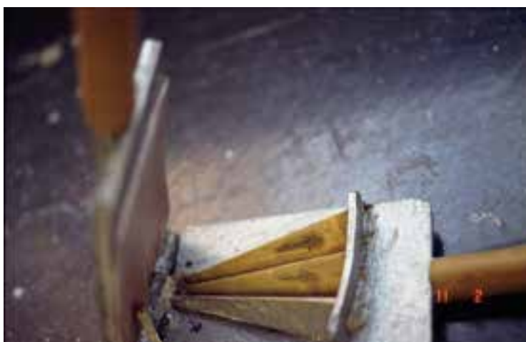
شکل ۳-۲۴- قالب ویژه ساخت مخروط‌های سنجش دمای خمیری [۷]
