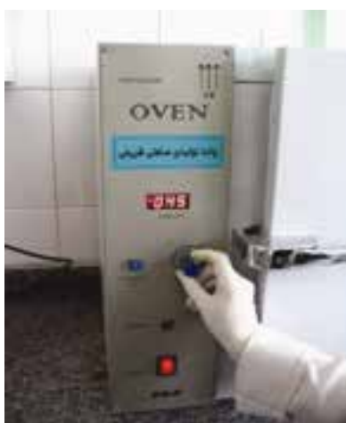
شکل ۲-۱۷- تنظیم خشک کن روی دمای ۴۵ درجه سلسیوس
