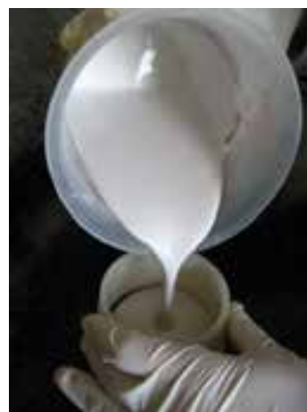
شکل ۲-۴- ریختن دوغاب گچ در حلقه ویکات
