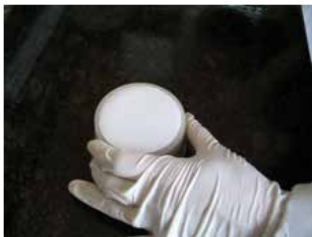
شکل ۲-۵- الف- حلقه ویکات پر شده توسط دوغاب گچ
