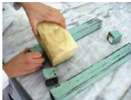
شکل ۲-۱۲- روغنکاری قالب ویژه آزمون نفوذ پذیری گچ
