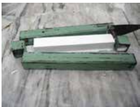
شکل ۲-۱۵- باز کردن قالب و خارج نمودن قطعه گچی
