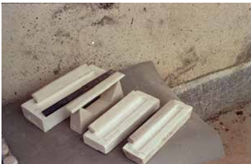
شکل ۳-۲۳- قالب گچی ویژه ساخت نمونه مقاومت پخت
