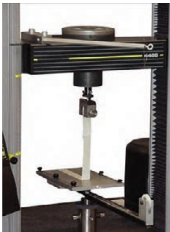
شکل ۲-۲- دستگاه پیشرفته اندازه‌گیری میزان چسبندگی انواع نوارها
