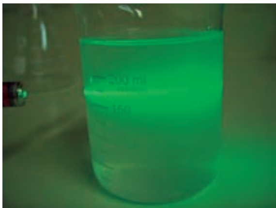
شکل ۲-۵- عبور نور از یک مایع کلوئیدی
