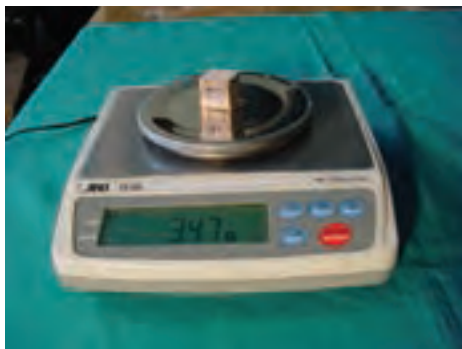
شکل ۳-۲- ترازوی دیجیتال برای وزن کردن نمونه
