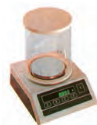
شکل ۳-۳- ترازوی سرپوش دار برای جلوگیری از تبخیر رطوبت
