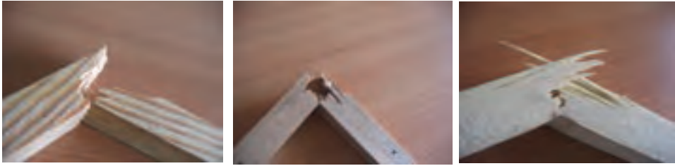
شکل ۶-۱- نوع شکست چوب زبان گنجشک در اثر ضربه
