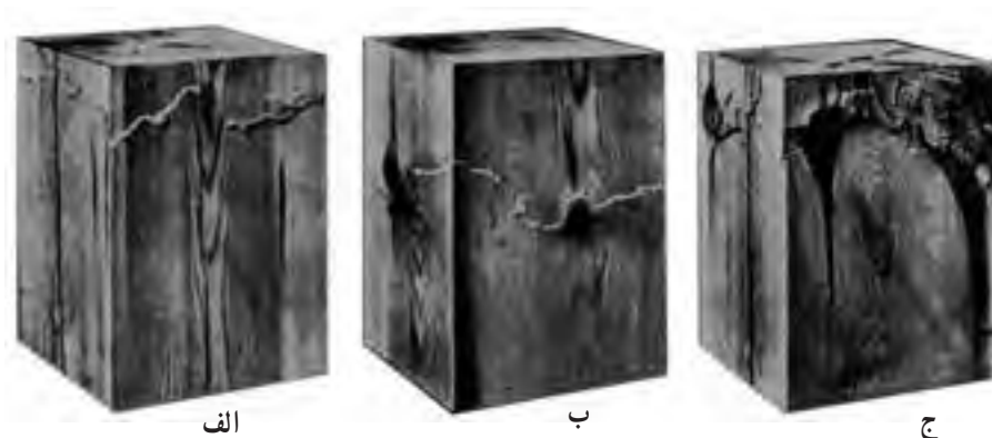
شکل ۹-۱۲— تأثیر گره بر مقاومت در برابر فشار موازی با الیاف
