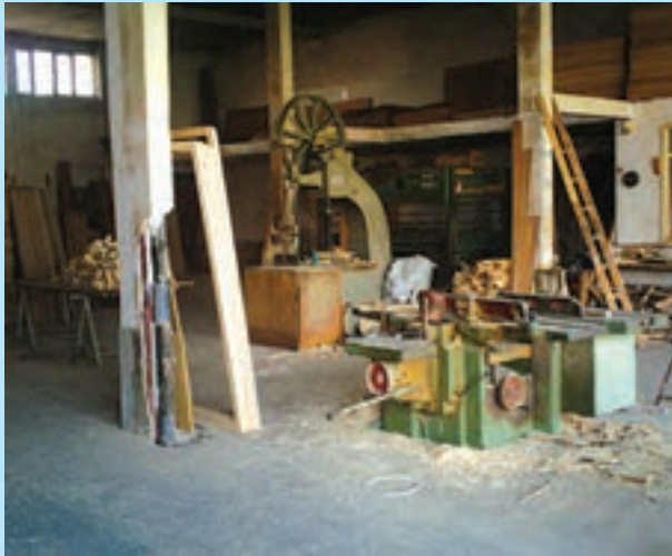
دستگاه‌های پنج کاره و اره فلکه و دستگاه پرس در انتهای تصویر مربوط به کارگاه نجاری
