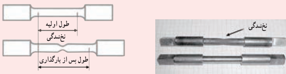
شکل ۲۱-۲۰- نمونه آزمایشی قبل از اعمال نیرو و پس از رسیدن به مرحله نخ شدگی
