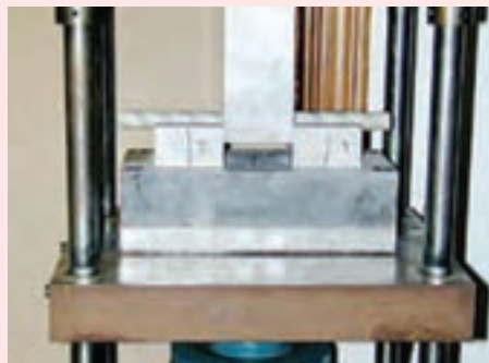
شکل ۷-۲۲- دستگاه آزمون استحکام کششی
