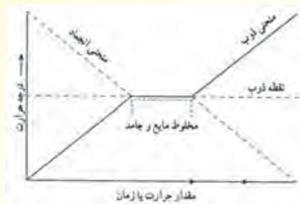
شکل ۱-۴- منحنی ذوب و انجماد فلز خالص
