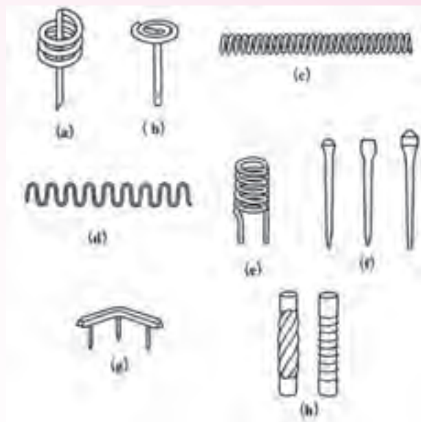
شکل ۳۹-۴. مثال‌هایی از مبردهای داخلی (a) مبرّد میخی مارپیچ (b) مبرّد میخی سر تخت (c) مبرّد فنری (d) مبرّد شبکه ای (e) مبرّد توپی (f) مبردهای میخی (g) مبرّد چندشاخه‌ای (h) مبرّد میله‌ای
