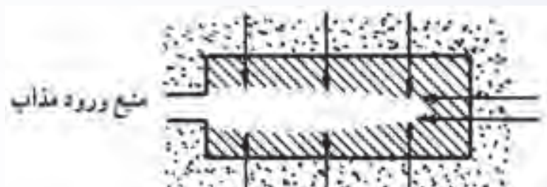
شکل ۳-۲۹- چگونگی ایجاد حفره های انطباقی در یک شمش ریختگی
