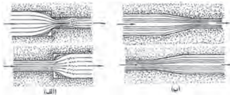
شکل ۸-۵- طراحی محل اتصال اجزای سیستم راهگاهی (الف) طراحی نادرست (ب) طراحی درست
