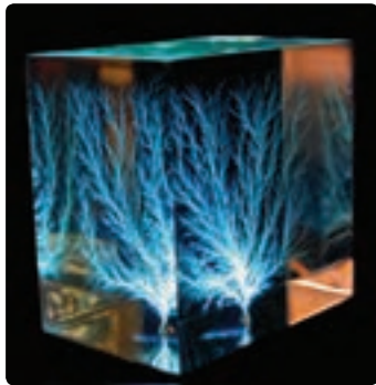
شکل ۱-۳۰ فروریزش الکتریکی باعث تشکیل مسیرهای رسانشی سرخس‌شکلی در دی الکتریک شده است.
