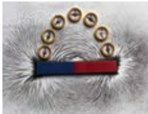
شکل ۳-۹ خط‌های میدان مغناطیسی در هر نقطه در جهت عقربه مغناطیسی هستند و از قطب N خارج و به قطب S وارد می‌شوند.
