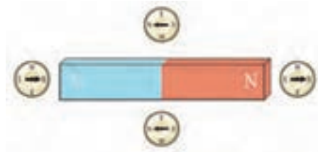
شکل ۳-۸ تعیین جهت میدان مغناطیسی به کمک عقربه مغناطیسی
