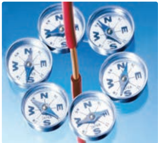
شکل ۳-۱۵ میدان مغناطیسی اطراف سیم حامل جریان را می‌توان با قرار دادن تعدادی عقربه مغناطیسی پیرامون آن نشان داد.
