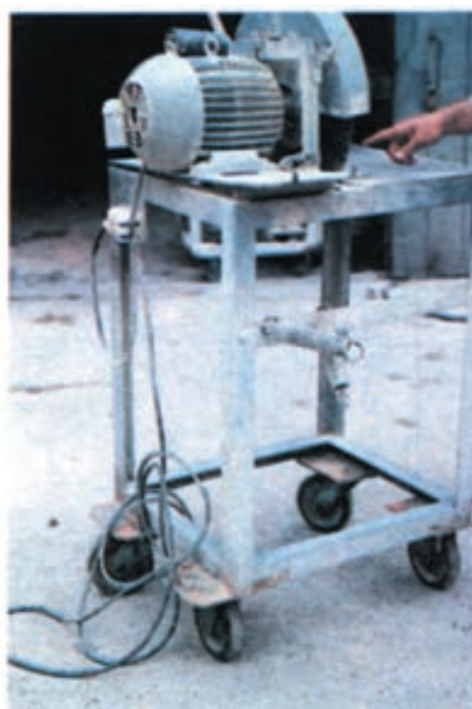
شکل ۹-۲ - دستگاه برش موزاییک و سنگ
