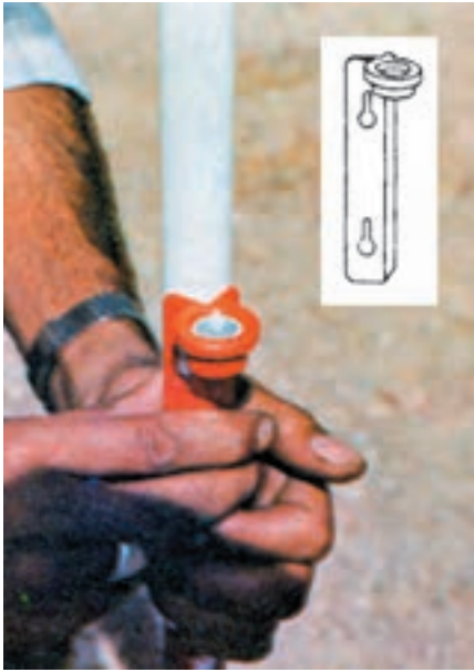
شکل ۱۰-۲- تراز نبشی و طرز استفاده از آن
