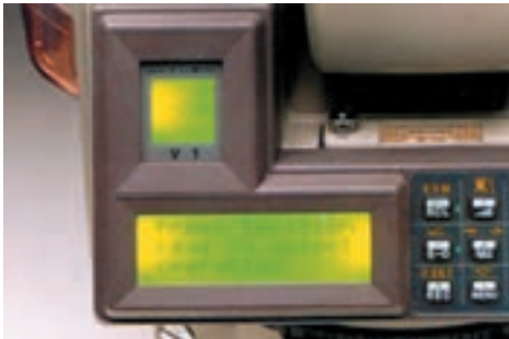
شکل ۷-۱- صفحه‌ی نمایش و بخشی از صفحه‌ی کلید دستگاه SET2C سوکیا
