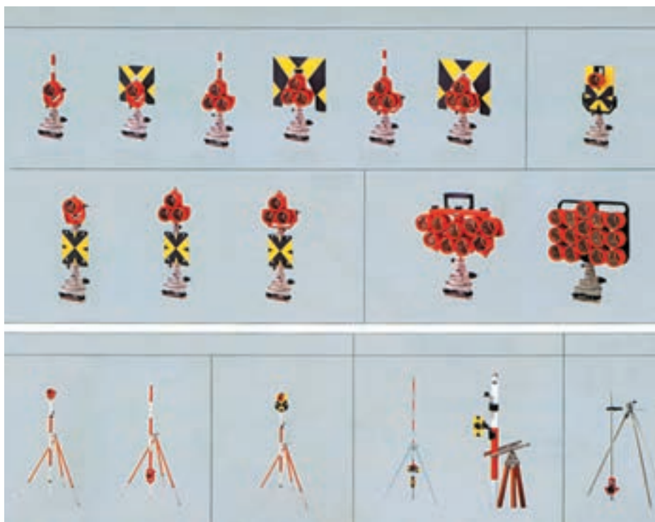
شکل ۷-۳- نمونه‌های مختلف منشورها و طرز استقرار آنها
