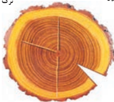
ترک تند باد (برق‌زدگی)
