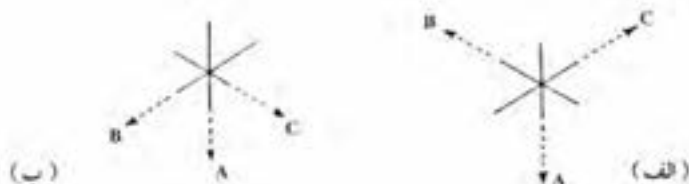
شکل ۳-۴- بهترین وضعیت انشیاب ساحلی برای تعیین نقطه کشتی با سه سمت
