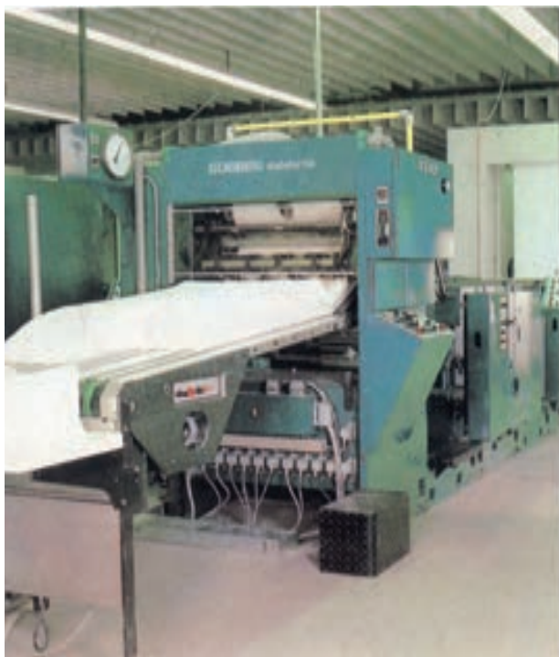
تصویر ۴-۲- یک ماشین چاپ افست (چاپ افست، نوعی چاپ همسطح است)
