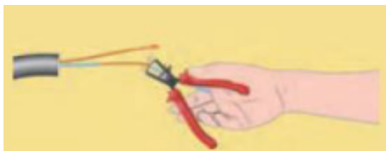
شکل ۳۸- چگونگی روکش‌برداری از سیم
