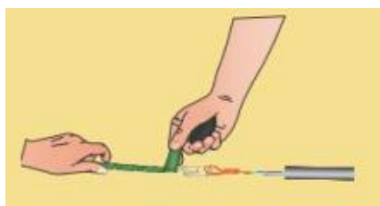
شکل ۴۳- چسباندن نوار چسب بر روی سیم
