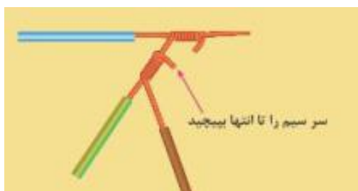
شکل ۴۰- تابانیدن سیم سوم
