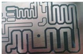
(چ) فیبر آماده شده را شست و شو دهید شکل ۹۰- مراحل ساخت فیبر مدار چاپی
