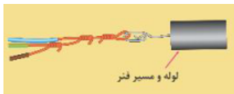
شکل ۴۲- اصلاح زائیده موجود در سیم
